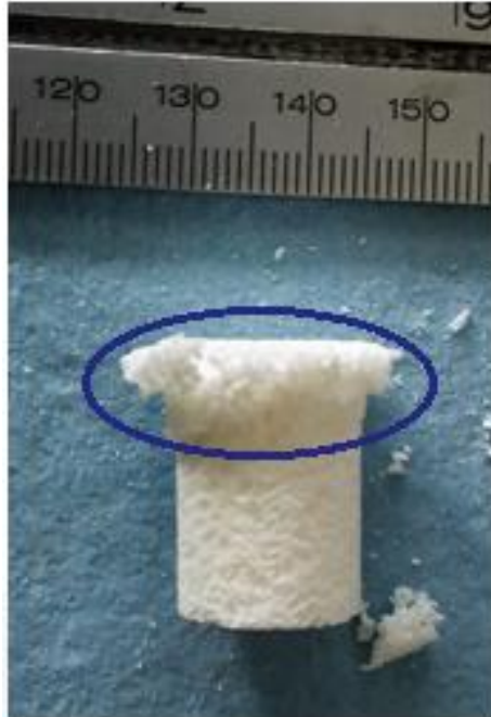
Fig. 19 Probeta 3 después de la prueba de compresión, se nota una "pulverización" de las trabéculas superiores, mientras que las inferiores parecen no haber sufrido cambio (izquierda).
