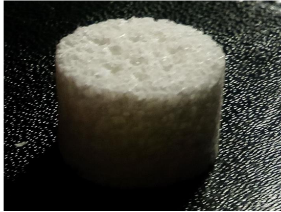
Fig.14 Probeta de Nukbone® después de realizar la prueba de dureza en el laboratorio CENISA.
