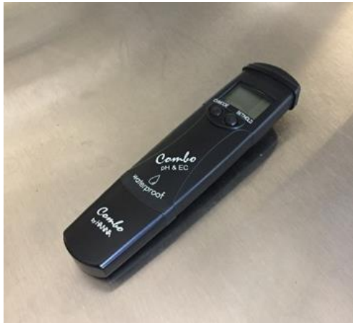
Figura 31. pH-metro de campo utilizado para medir el pH de la solución
