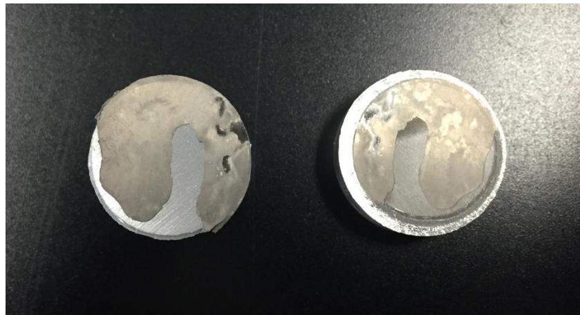
Figura 61. Primera probeta sometida a la prueba de Pull – Off, en el lado izquierdo se encuentra el dollie con la capa de recubrimiento desprendida.
