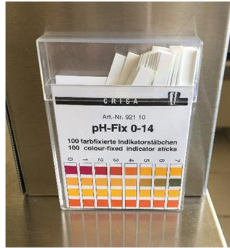
Figura 32. Papel tornasol para medir el pH de la solución
