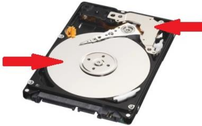
Figura 16. Partes recubiertas en un disco duro de computadora
