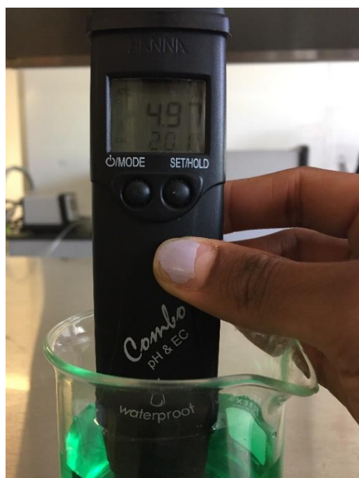
Figura 47. Valor medido con el pH-metro del pH de la solución de niquelado químico
