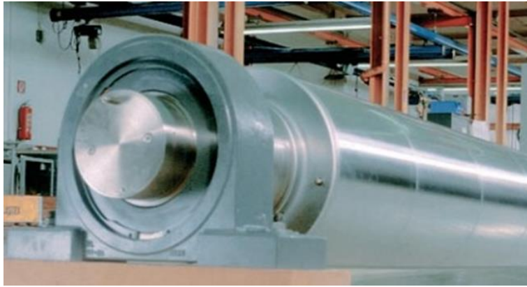
Figura 19. Los rodillos son recubiertos por niquelado químico para reforzar el material base aumentando su vida útil
