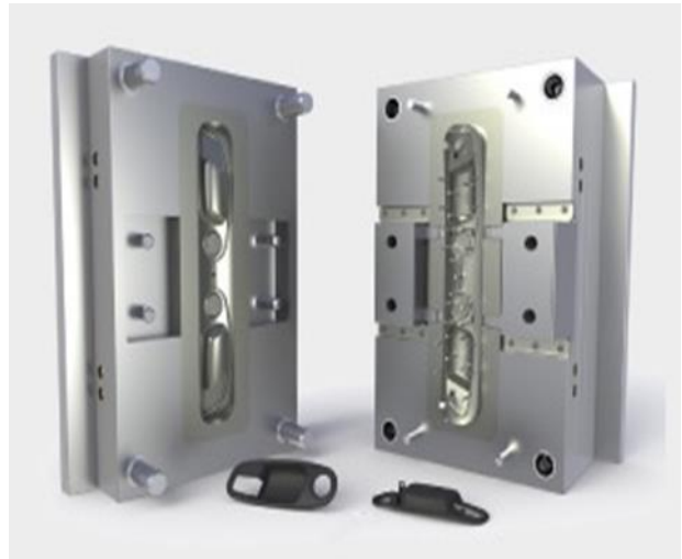
Figura 18. Moldes para inyección de plásticos, como proceso final de manufactura, son recubiertos por niquelado
