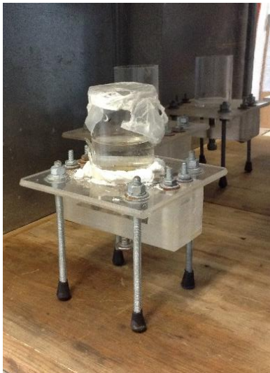
Figura 43. Celda donde se realizaron las pruebas de espectroscopia de impedancia electroquímica
