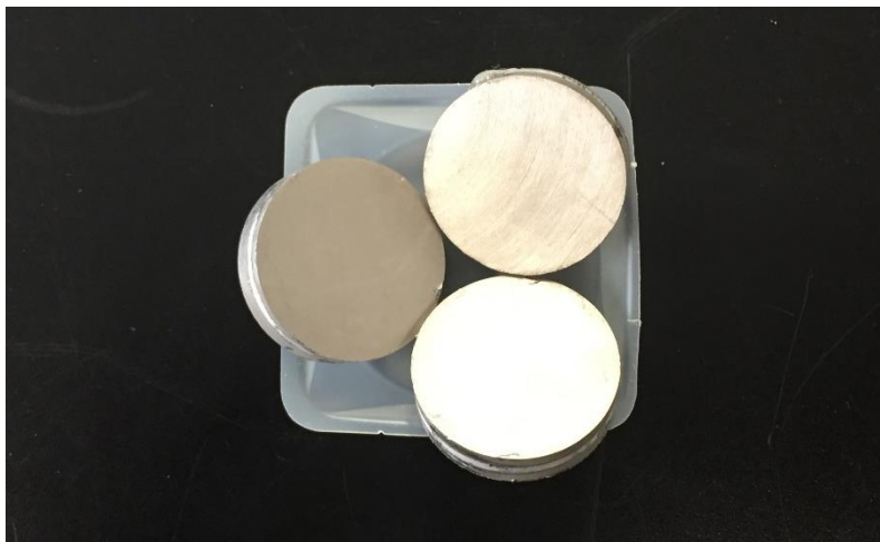
Figura 41. Muestra a las probetas recubiertas después del proceso limpieza
