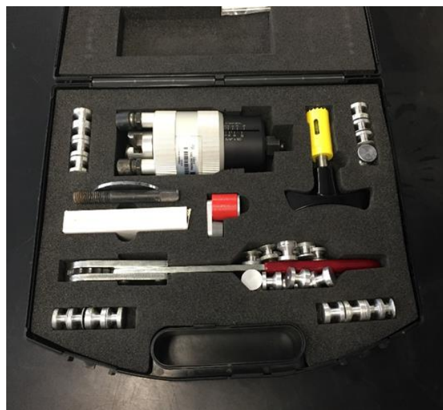
Figura 39. Equipo para realizar prueba de adherencia (Pull – Off)
