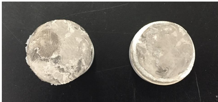
Figura 63. Tercer probeta sometida a la prueba de Pull – Off, en el lado izquierdo se encuentra el dollie con la capa de adhesivo desprendida de la probeta, y está en el lado derecho con el recubrimiento casi intacto
