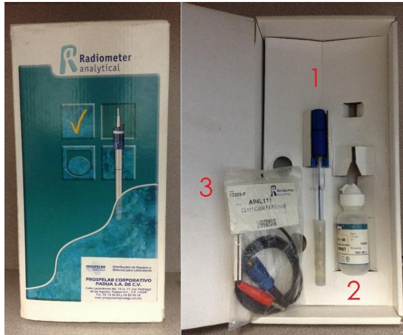
Figura 45. Caja que contiene al electro de referencia y sus accesorios
