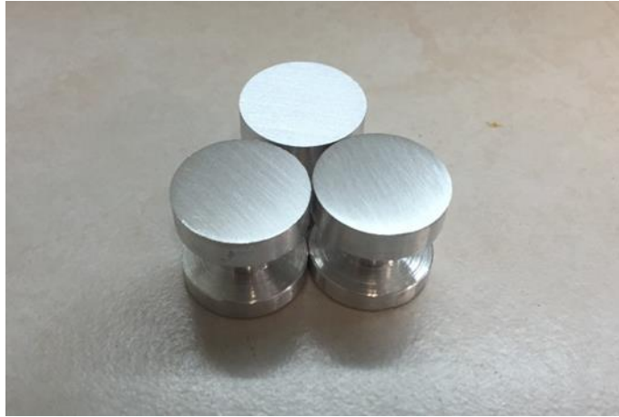
Figura 40. Muestra a los dollies después del proceso de lijado y limpieza
