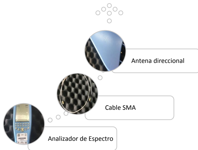
FIGURA 5.3 ESQUEMA DE CONFIGURACIÓN DEL ANALIZADOR DE ESPECTRO
