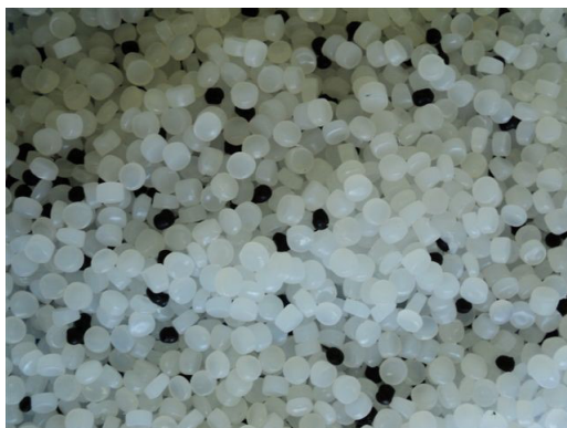
Figura 1.1: Adición de aditivo anti-UV al PEAD (Recuperado de [1]).
