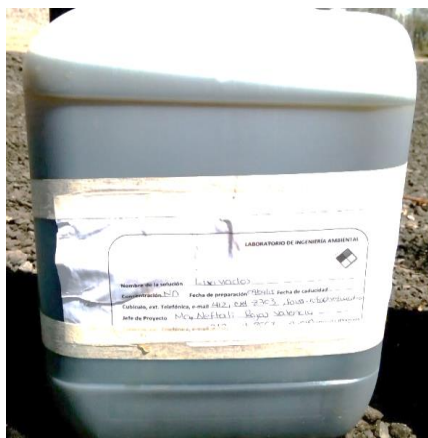
Figura 5.3. Fotografía de lixiviados muestreados en la etapa III del RSBP
