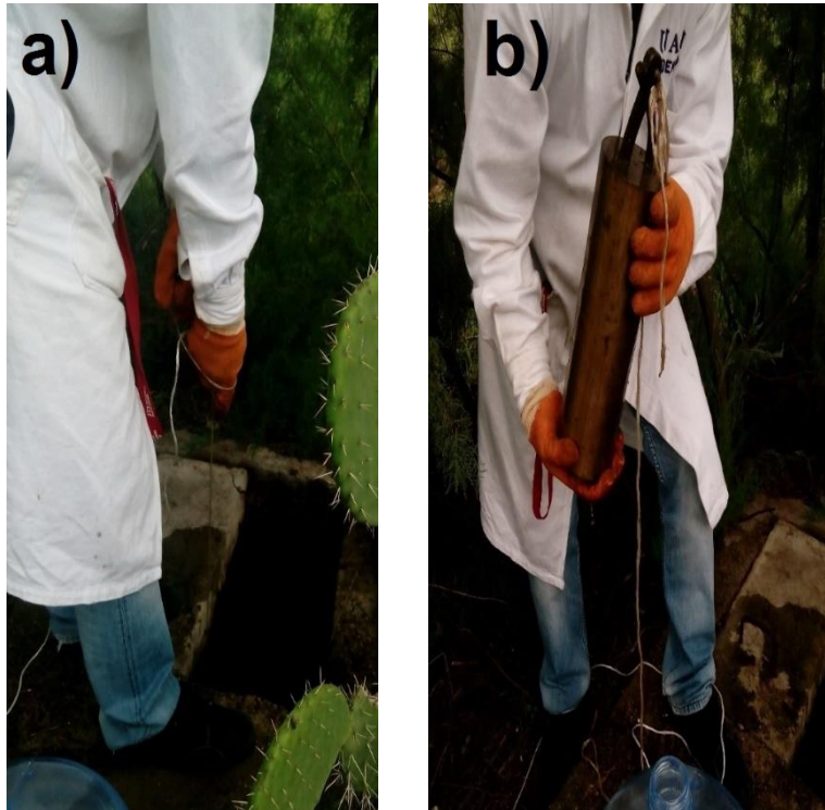
Figura 4.12. Procedimiento de muestreo de lixiviados en la etapa III del RSBP. a) Ingreso del muestreador Winkler. b) Muestreador con lixiviado
