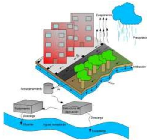
Ilustración 4.1 Esquema de modelación SWMM.
