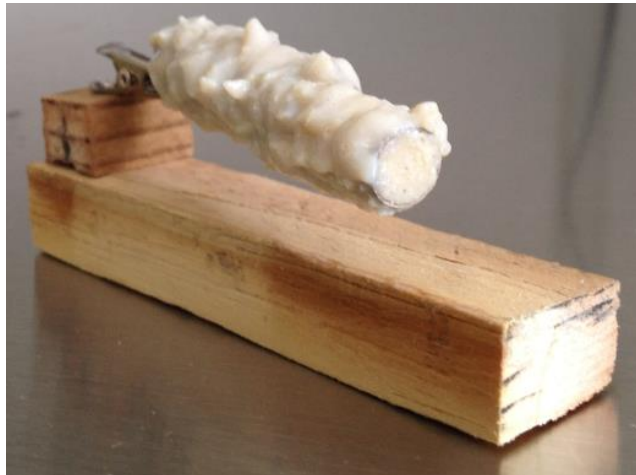
Figura 4.21. Tubo de Aluminio cubierto de fluoropolímero, incorporado en forma de coloides.
