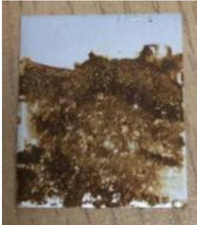
Figura 4.18. Probeta con fluoropolímero después de 105 días
