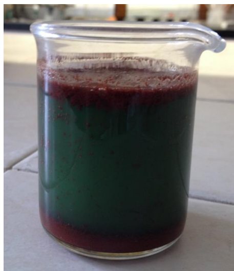
Figura 4.1. Electrolito ( \text{NaO}_3\text{V} con \text{H}_2\text{SO}_4 ) contaminado por la barra de grafito.
