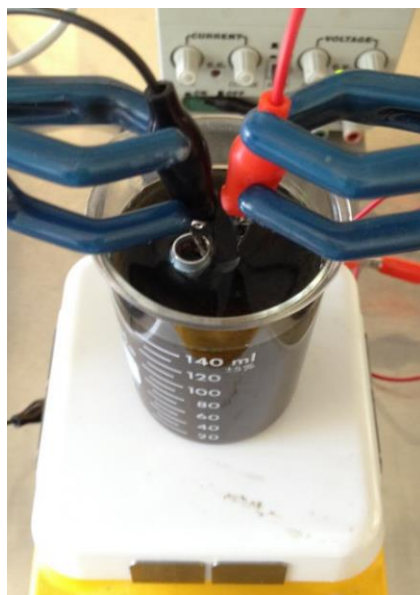
Figura 4.20. Anodizado de tubo de aluminio.
