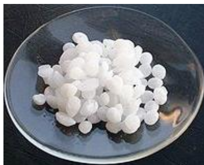
Figura 3.2. Hidróxido de sodio utilizado para hacer la disolución para la limpieza (NaOH).
