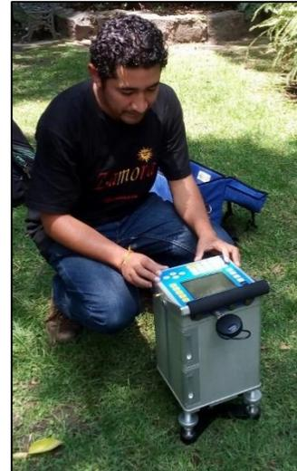
Figura 5.2. Toma de datos con gravímetro. Modelo CG-5 AUTOGRAV.
