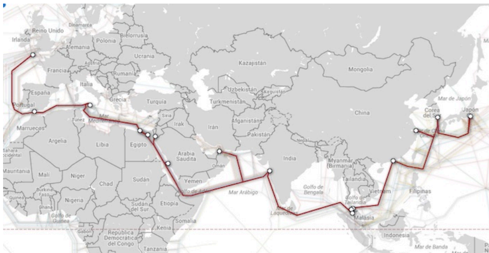
Figura 6. Cable Submarino de fibra óptica “FLAG Europe-Asia”
