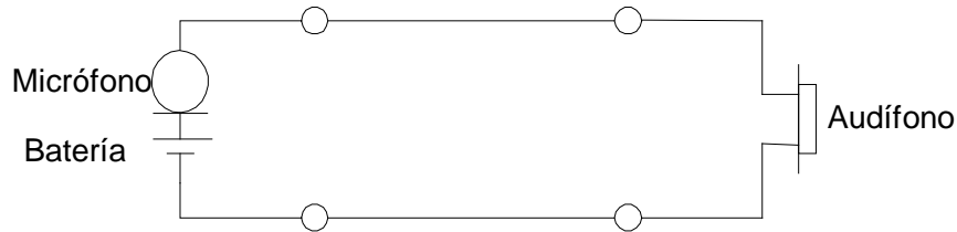
Figura 1.2. Circuito telefónico simple.
