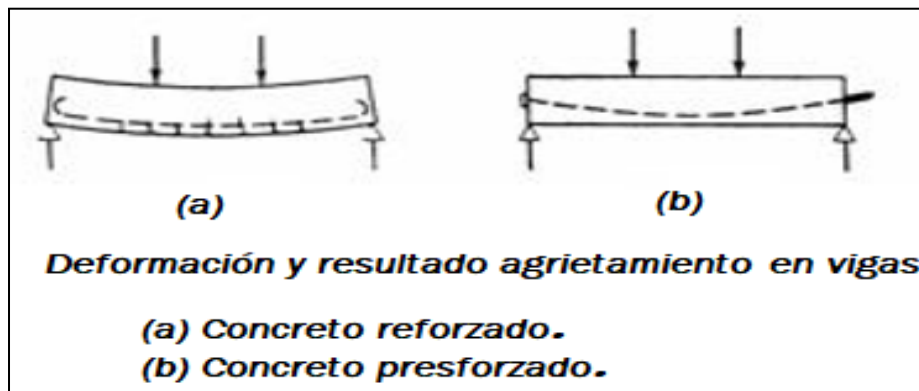
Figura 22. Fisuras presentadas en miembros reforzados y presforzados.
