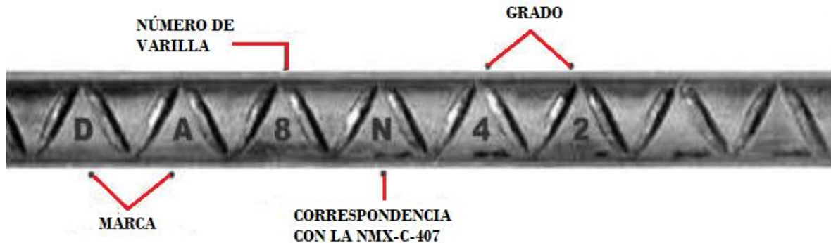
Figura 28. Identificación de varillas en la NMX-C-407-ONNCCE-2001.
