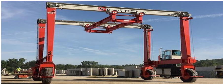
Figura 19. Marco pórtico SHUTTLELIFT empleado en planta PRET “La Arboleda”.
