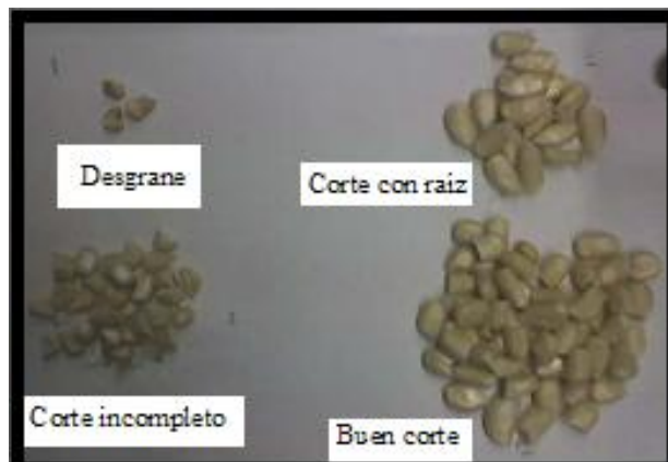
Fotografía 2.6. Muestra del corte de los granos de maíz con cuchilla.
