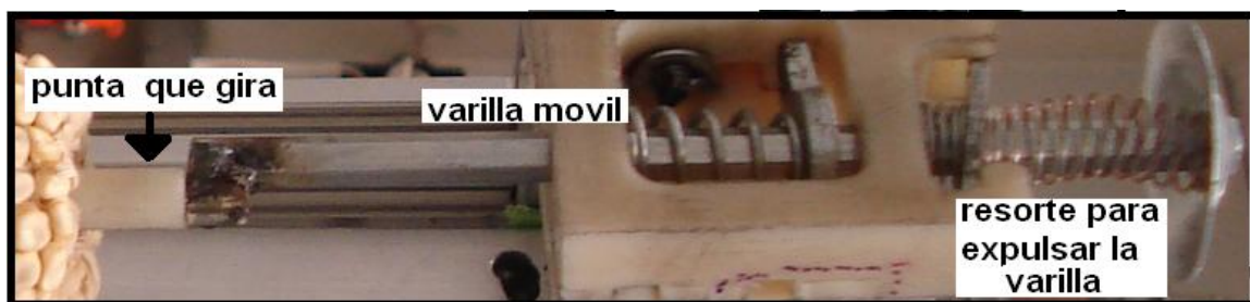
Fotografía 3.2. Diferentes elementos para sujetar la mazorca por el lado de mayor diámetro.
