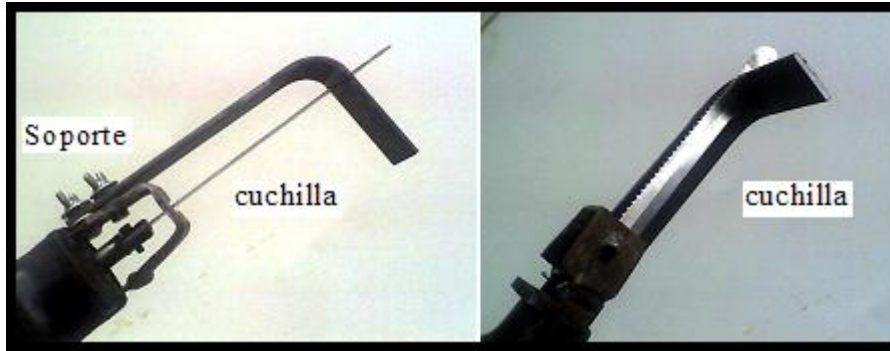
Fotografía 2.3. Soporte y cuchilla del sistema con cuchilla dentada, vista frontal y lateral.
