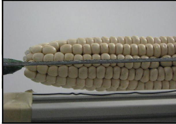
Fotografía 4.3. Modo en el cual se introduce la mazorca, con respecto a la sierra cinta.
