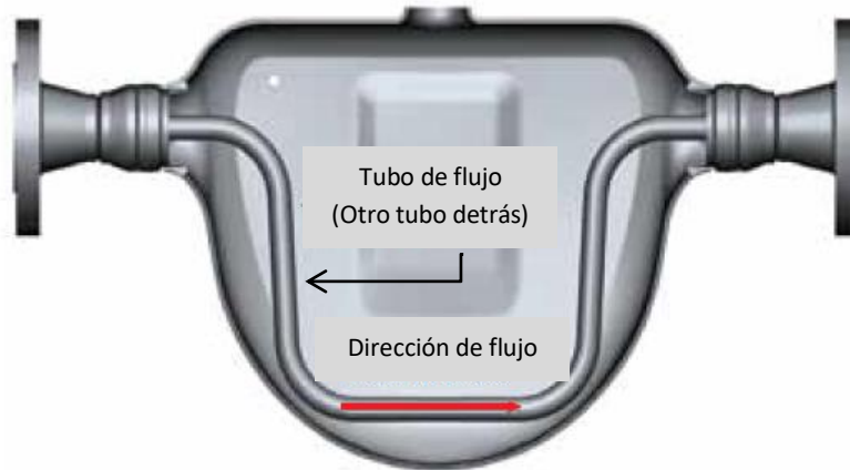
Figura 2.1: Un medidor tipo Coriolis básico, consiste en dos tubos curvos (sólo uno visible aquí) a través de los cuales pasa el flujo con un controlador electromagnético en el medio y sensores de movimiento en ambos extremos. (O'Banion, 2013)
