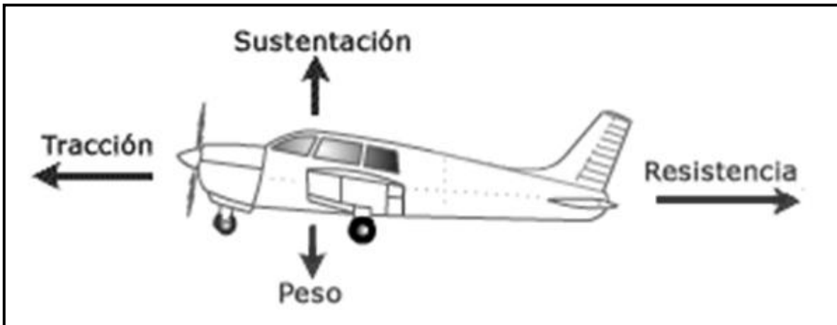
Ilustración 8 Fuerzas a las que se somete una aeronave [23]
