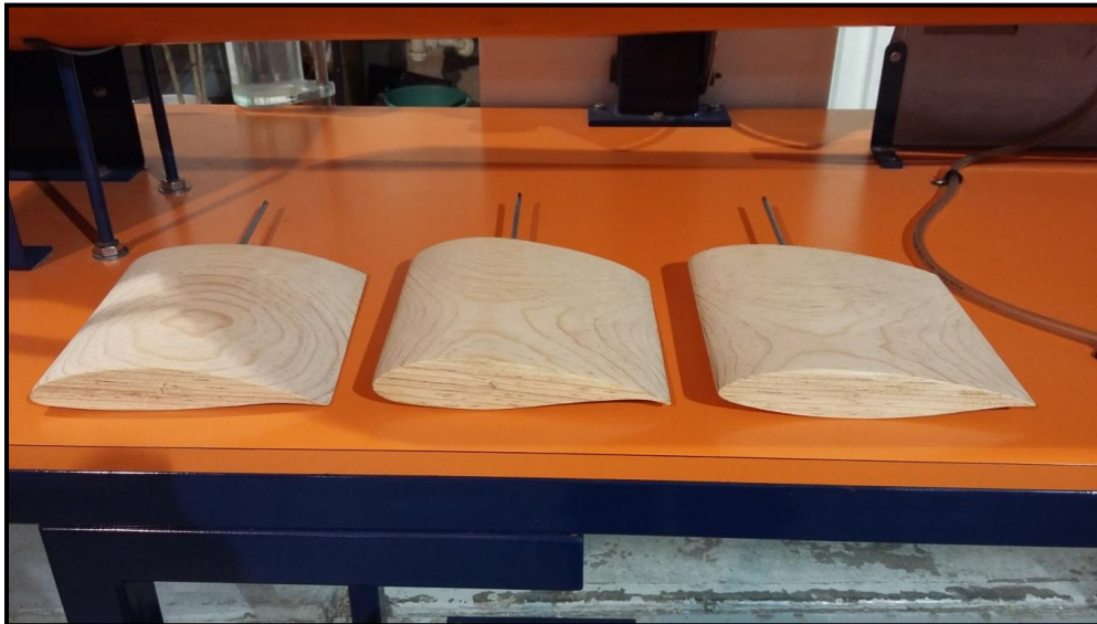
Ilustración 30 Perfiles alares fabricados en madera [21]
