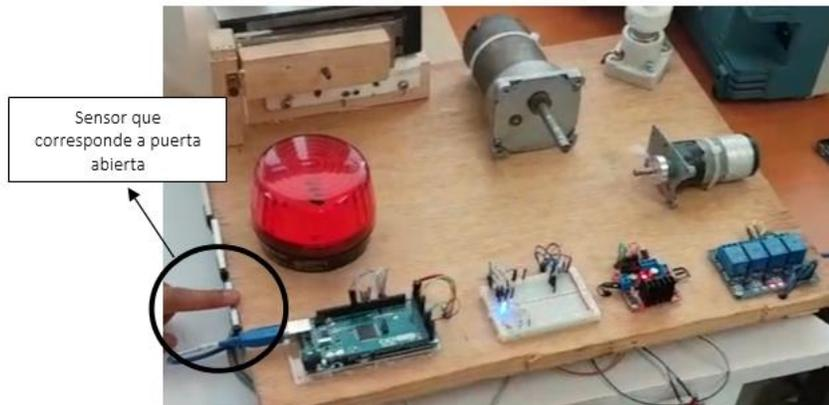
**Ilustración 37** El motor está en movimiento y al presionar el sensor de puerta abierta se detiene. Después se presiona el sensor que corresponde a la detección del usuario, es decir que el usuario ya cruzó la puerta y la puerta puede comenzar a cerrar, una vez que se presiona el sensor, el motor comenzó a girar en sentido contrario, representando que es en el cual la puerta se cierra.
