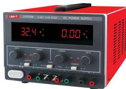
**Ilustración 14 Fuente de voltaje variable**
