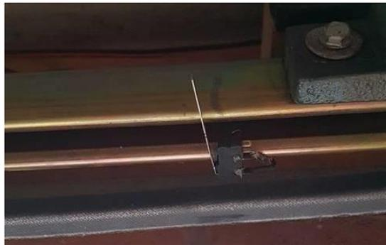
**Ilustración 56 Sensor de puerta abierta**
