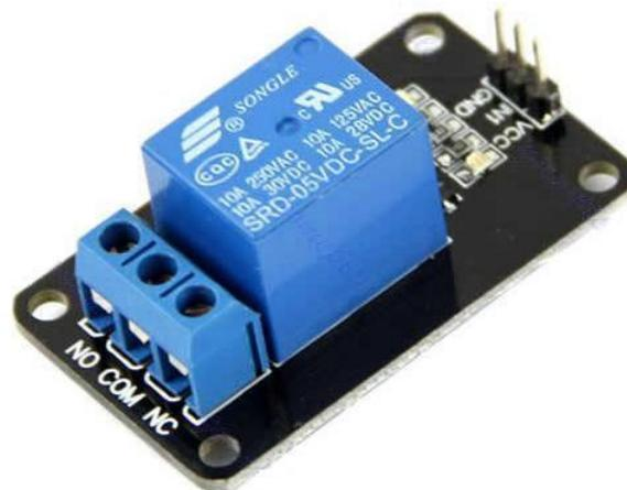
**Ilustración 26 Módulo con relevador unitario**
