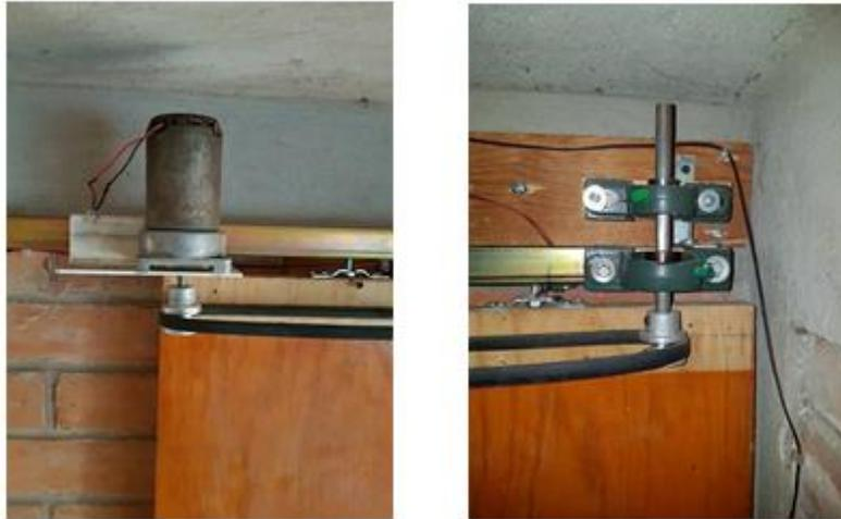
Ilustración 54 motor y chumaceras fijadas al riel
