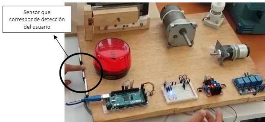
**Ilustración 30** El motor está detenido, al presionar el sensor que detecta al usuario el motor **comienza a moverse.**
