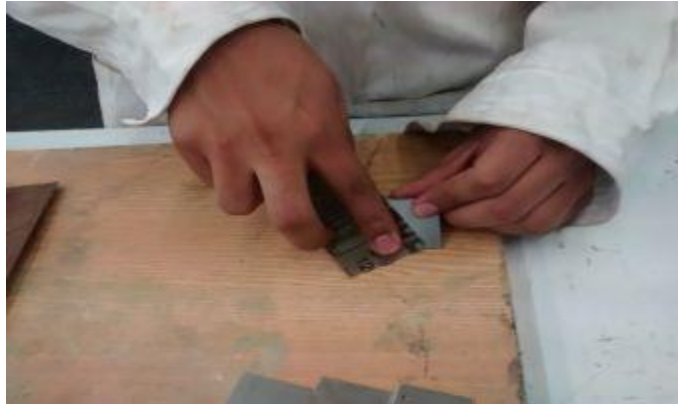
Figura 4.8. Etapa de limpieza mecánica
