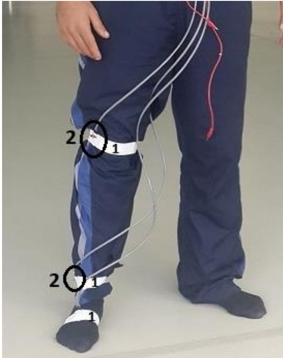
Figura 2.7. Colocación de los acelerómetros y giroscopios al cuerpo.
