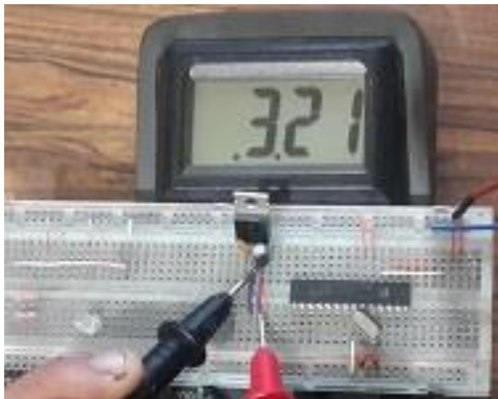
Figura 2.9 Voltaje entregado a la salida del regulador de voltaje.
