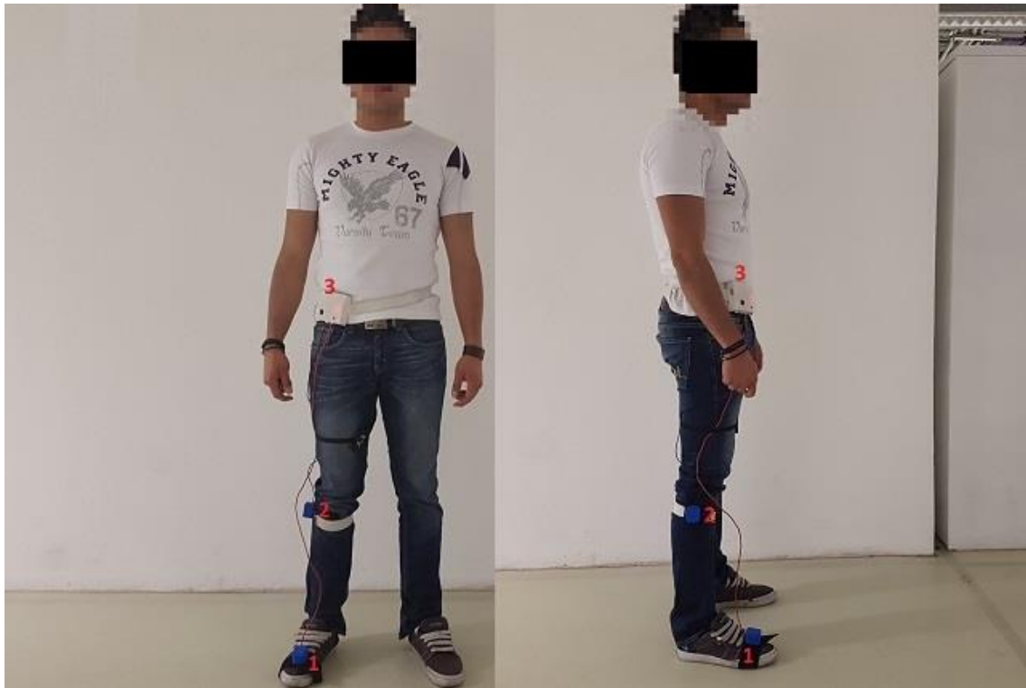
Figura 3.3 Colocación del dispositivo.
