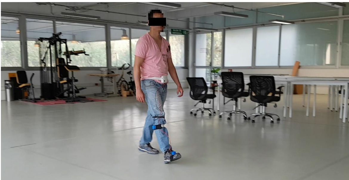
Figura 2.38. Sujeción de las IMU's durante la marcha.
