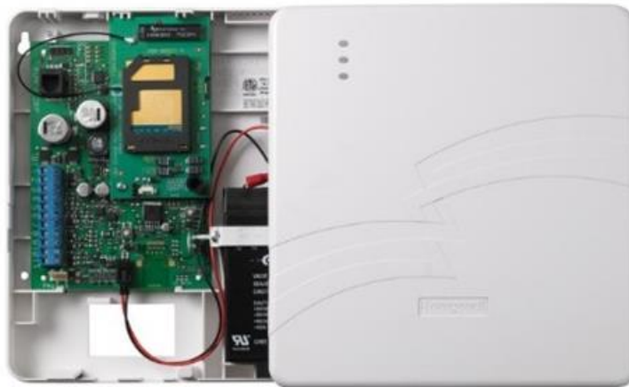
FIG. 5.12 - Comunicador IP HONEYWELL modelo 7847I.
