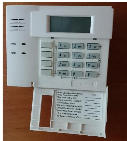
FIG. 5.14 - Terminal remota para alarma.
