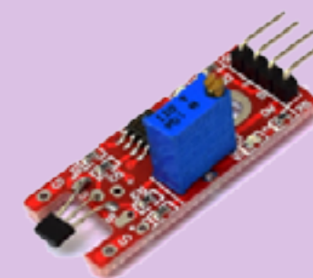
Figura 44. Módulo Sensor de Efecto Hall (izquierda) [55] y Ejemplo de desfase de imanes en dos discos (derecha) [56].PNG
