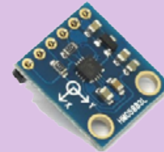
Figura 48. Módulo Magnetómetro HMC5883L [57].PNG
