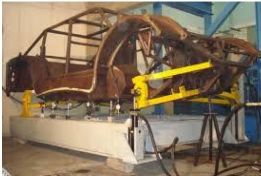
Fig. 1-15 Banco de pruebas mediante actuadores hidráulicos [25]
