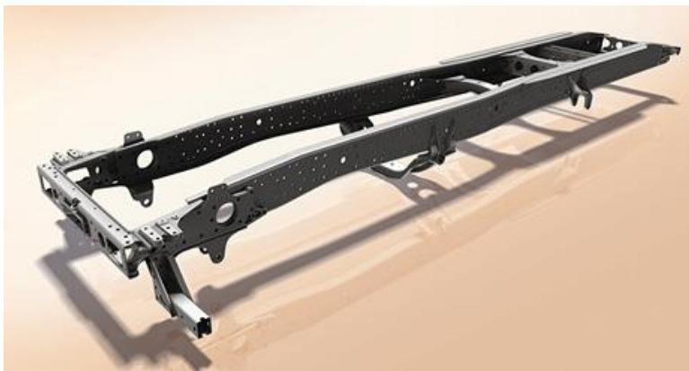
Fig. 1-2 Chasis formado por largueros y travesaños [12]
