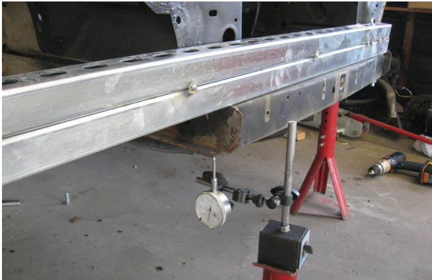
Fig. 1-10 Indicador de caratula para la prueba de rigidez torsional [21]
