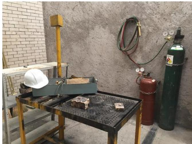
**Figura 8.** Equipo para soldadura autógena
