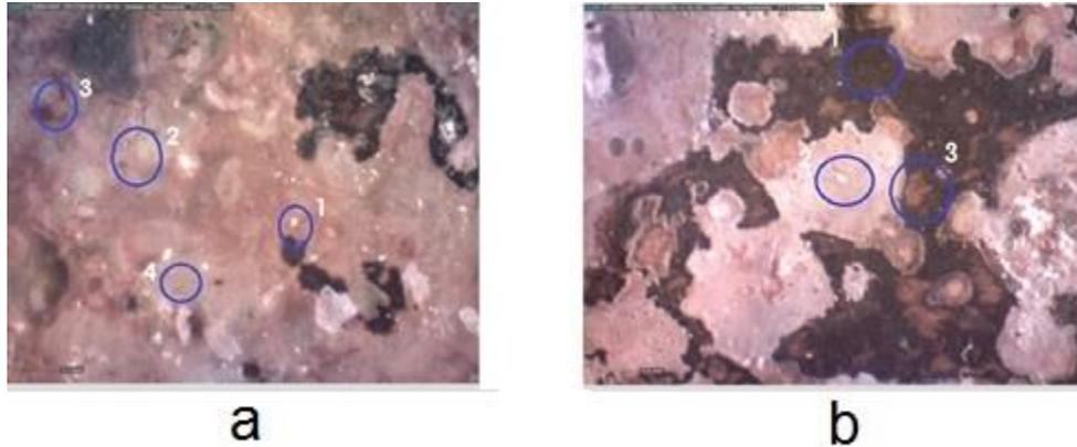
**Figura 26.** Imagen tomada con el estereoscopio de la probeta pátina bórax 1.
