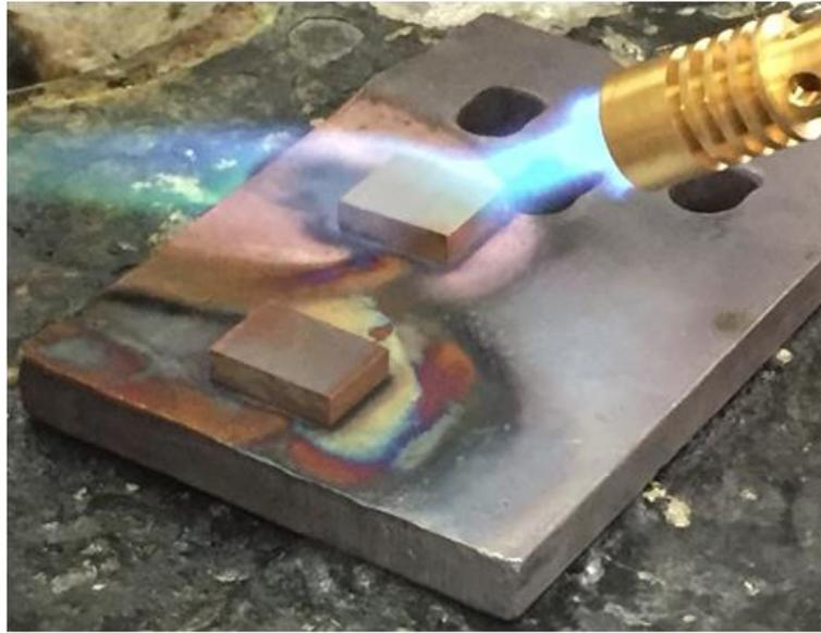
**Figura 7.** Probeta al ser calentada con gas propano
