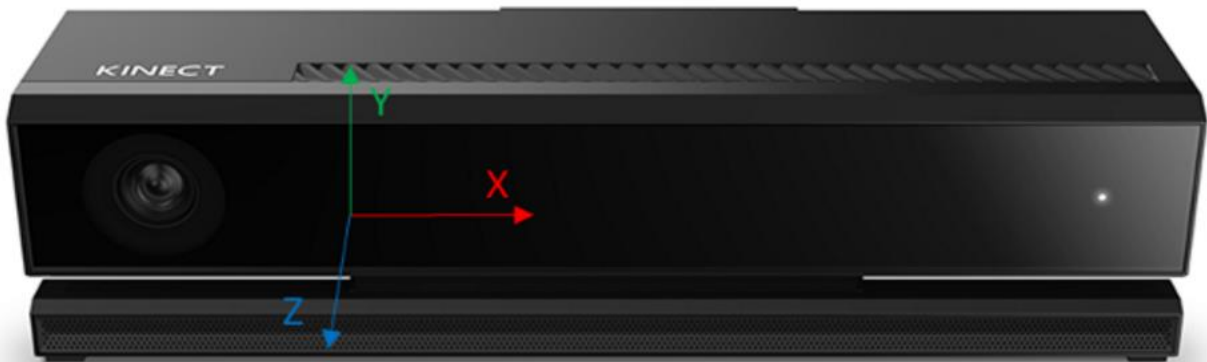
Fig. 3.6 - Sistema de coordenadas del espacio de la cámara y por extensión de esqueleto del Kinect. Tomado de: [25]
