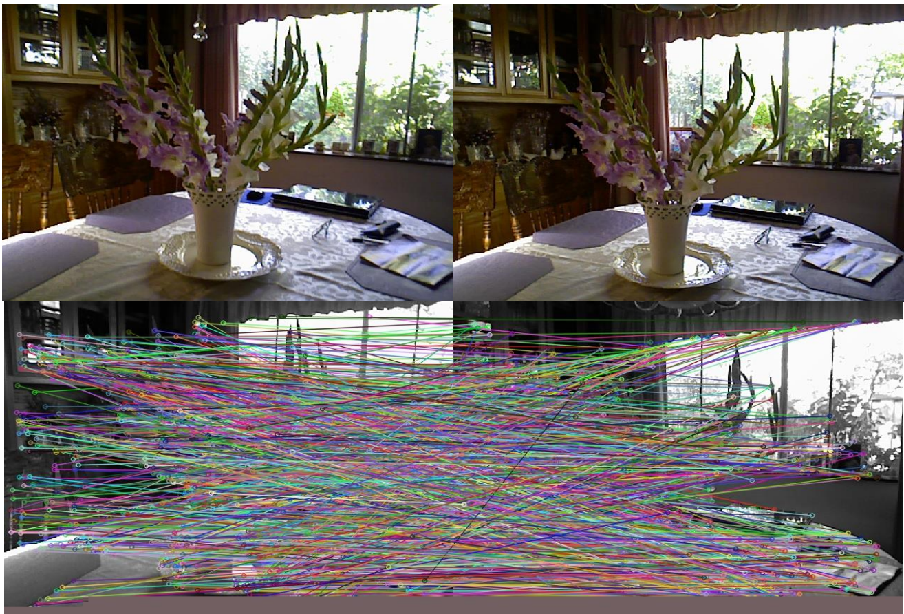
Fig. 3.9 – Matching entre dos capturas realizado con FLANN para características SIFT en OpenCV.
