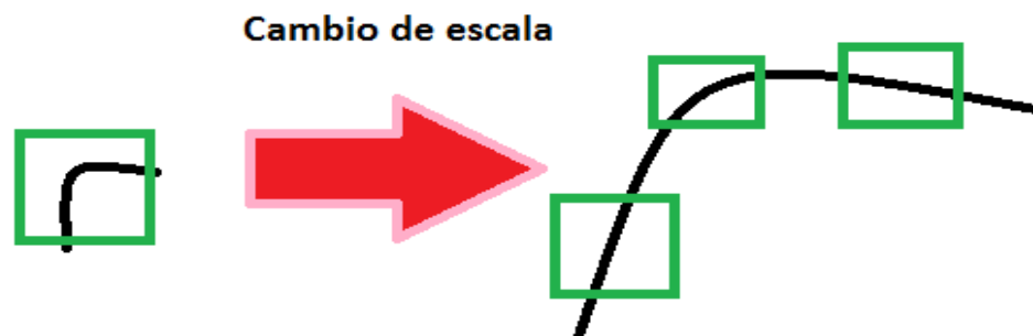
Fig. 2.4 - Demostración de variación en propiedades visuales de una esquina con la escala.
