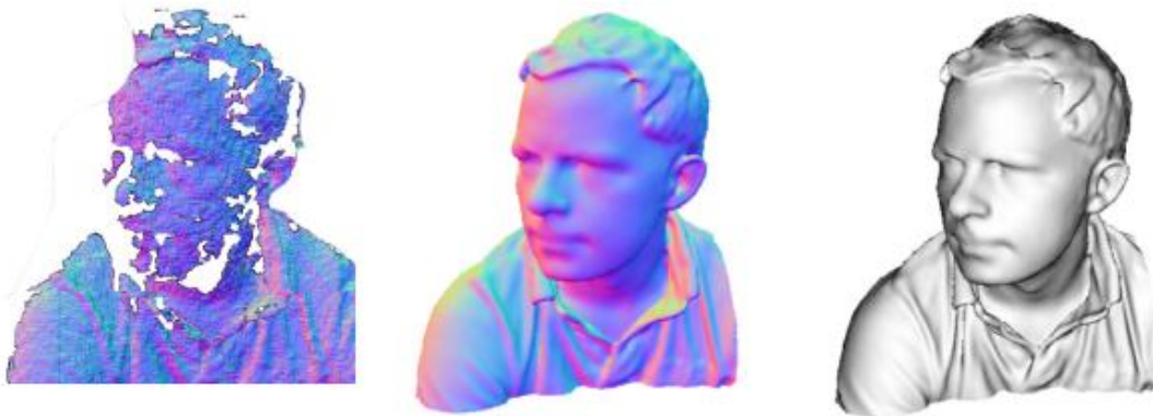
Fig. 3.7 - De izquierda a derecha: Información de entrada de Kinect Fusion tomada directamente del sensor Kinect aún con ruido e incompleta, salidas de Kinect Fusion generadas únicamente con la información del sensor de profundidad como mapeados en tiempo real a color y sombreado en escala de grises respectivamente. Tomado de: [26]
