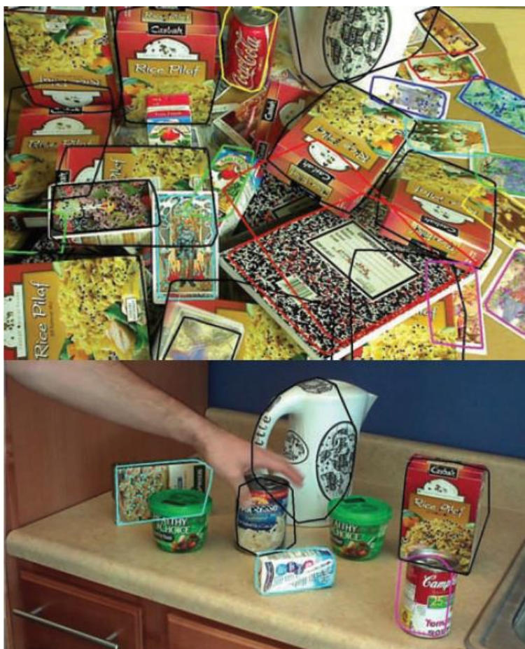
Fig. 2.13 – Reconocimiento de objetos con escenas del mundo real. (Arriba) Escena de alta complejidad donde MOPED reconoce 27 objetos, algunos parcialmente cubiertos. Usando una base de datos con 91 modelos y una resolución de imagen de 1600x1200. (Abajo) Escena de complejidad intermedia donde MOPED procesa la imagen de 640x360 en 87ms y encuentra todos los objetos, (exceptuando la lata verde de sopa ya que no está en la base de datos). Tomado de: [7]
