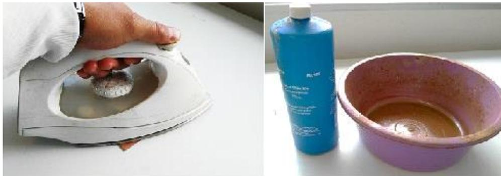
**Fig. 2.23** Pasos del método de transferencia térmica. Planchado y ataque con ácido clorhídrico.
