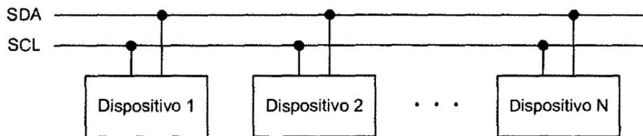
Fig. 6 Conexión de dispositivos mediante I<sup>2</sup>C. [6]
