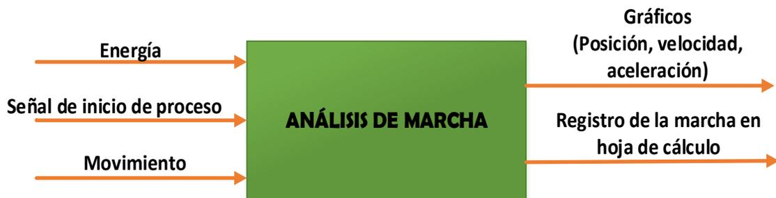
Fig. 2.2 Caja de funciones del sistema en general.
