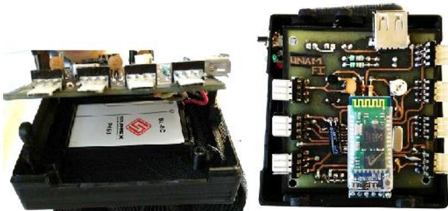
Fig. 2.47 Circuito con la batería embebidos en la caja contenedora.
