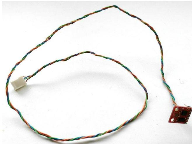
**Fig. 2.26** IMU con cable trenzado para eliminar el ruido.
