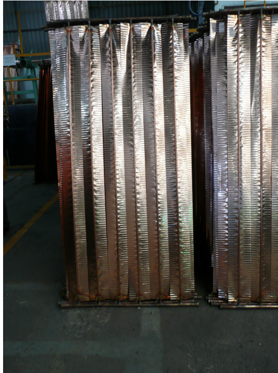
Ilustración 7: Absorbedor montado previo al proceso de pintado
