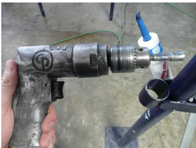
Ilustración 11: Taladro neumático utilizado en los procesos de cierre final
