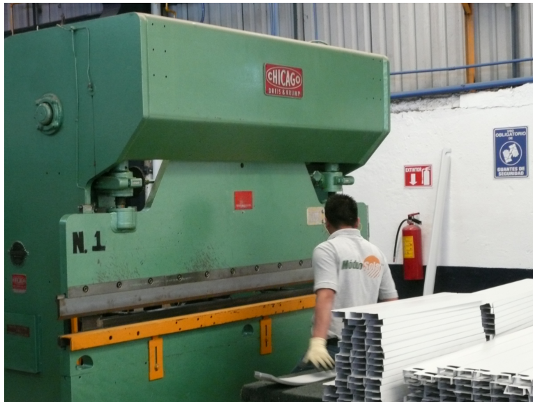
Ilustración 8: Dobladora empleada para habilitar la lámina pintro utilizada en la caja del calentador
