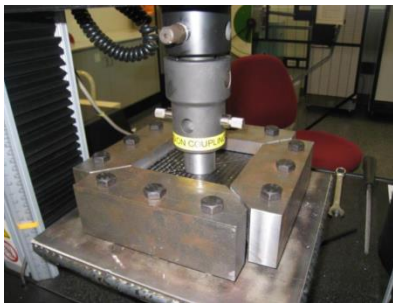
Figura 3.16 Prueba de extracción de la montura [James, 2010]
