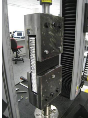
Figura 3.15 Ensayo a corte de las monturas [James, 2010]
