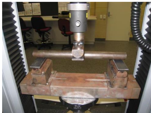
Figura 3.6 Ensayo a flexión en 3 puntos de tubo de acero [James, 2010]
