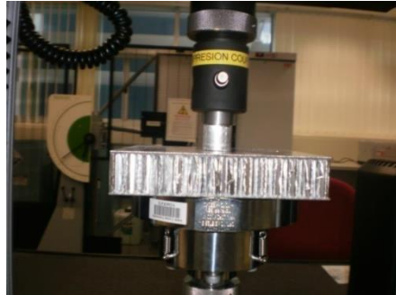
Figura 3.11 Ensayo a cortante realizado por el equipo ECU Racing [James, 2010]
