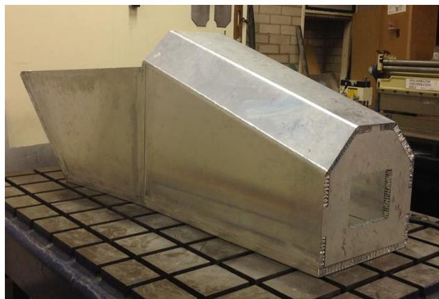
Figura 1.7 Monocasco de aluminio del prototipo CR10 del equipo Cardiff Racing [Cardiff Racing Facebook, 2013]
