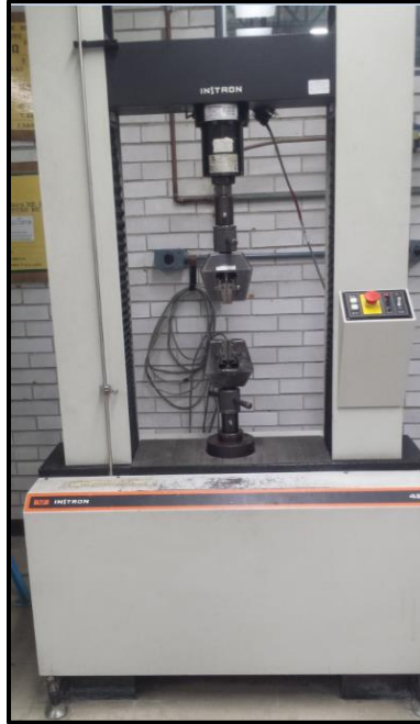
Figura 53. Máquina Instron para ensayo de tracción.
