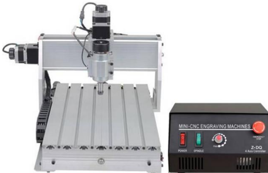
Figura 43. Fresadora mini CNC. Tomado de (China CNC Zone, 2017).
