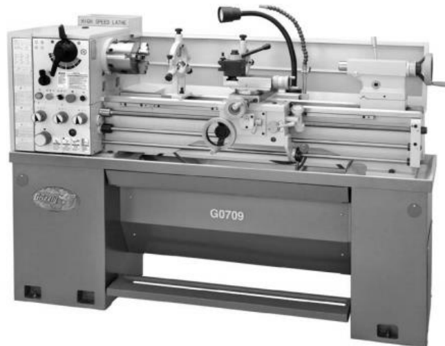
Figura 44. Torno modelo Grizzly G0709 tomado de (GRIZZLY INDUSTRIAL INC., 2014).
