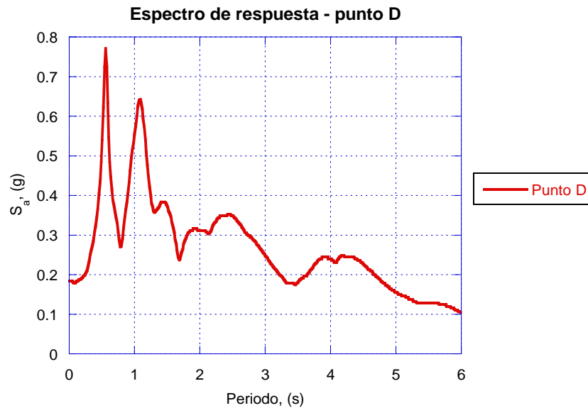
Fig. 6.56 Espectro de respuesta del suelo en el punto D analizado
