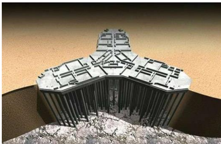
Figura 1.1 Cimentación de losa con pilotes
