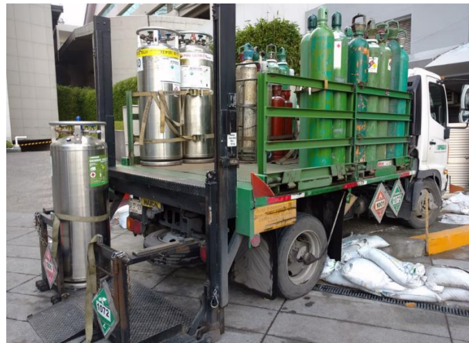
Ejemplo de vehículo de distribución entregando en las instalaciones del cliente (Se observa contenedor de oxígeno líquido portátil en la rampa hidráulica).
