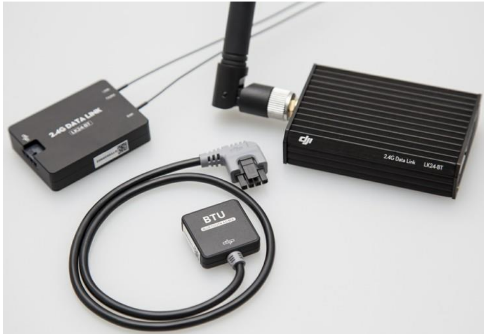
Imagen de los tres componentes que constituyen el equipo bluetooth para controlar la modalidad waypoints del Phantom 2.
