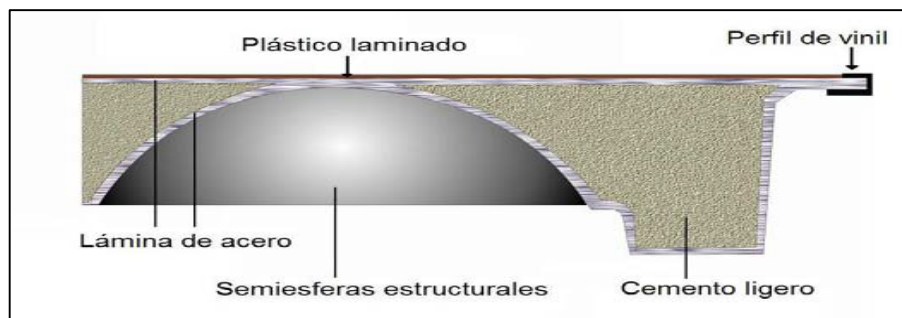
Figura 5.18 Componentes de la baldosa/piso técnico
