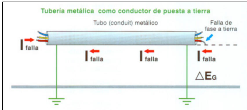
Figura 4.42 Tubería metálica usada como electrodo de puesta a tierra.
