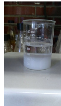
Fig. 2.2.a) Imagen de la solución del tetracloruro de circonio e hidróxido de sodio en agua deionizada agitándose .b) Imagen del precipitado del hidróxido de circonio en el fondo del vaso de precipitados.
