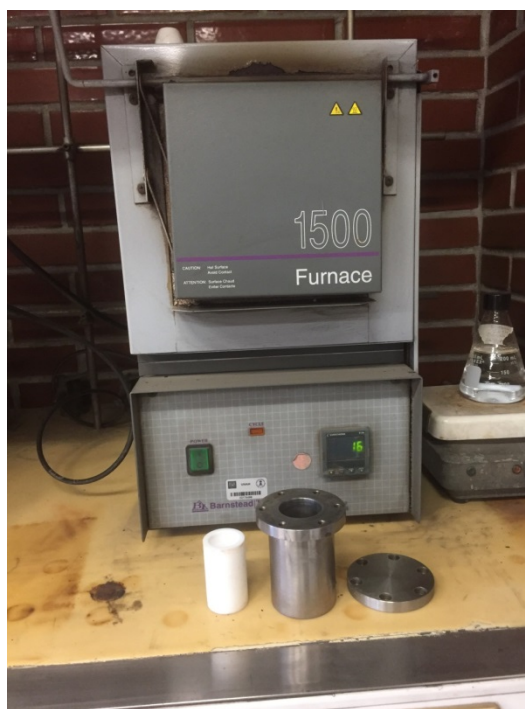
Fig. 2.3. Horno y porta muestras utilizados en el experimento.
