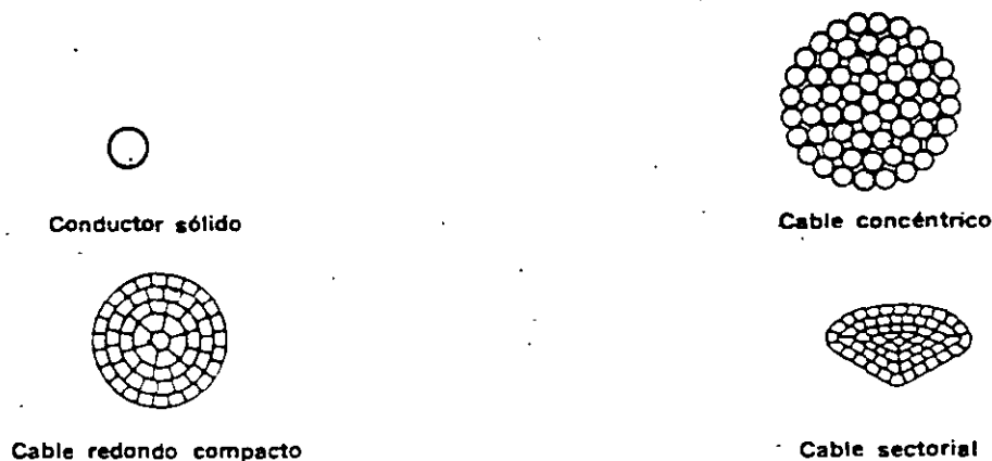
Fig. 1.1 Forma de conductores.
