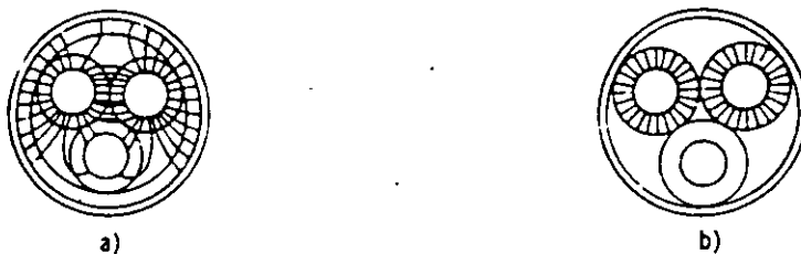
Fig. 3.3 a) Cable sin pantalla. b) Cable con pantalla.
