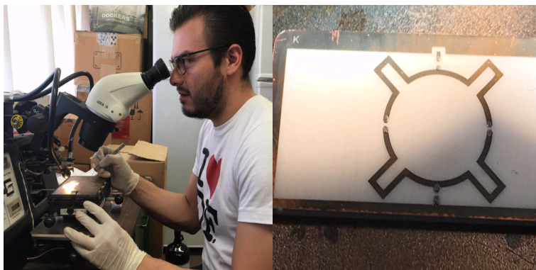
Figura 4.1.2.4.2 Colocación de la soldadura en pasta.
