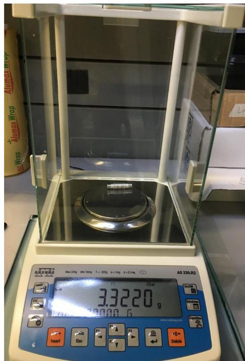
**Figura 15.** a) Medición de la longitud de la muestra b) Registro del peso de las muestras tipo barra en una balanza analítica. Se observa la muestra en el centro del plato de la balanza.
