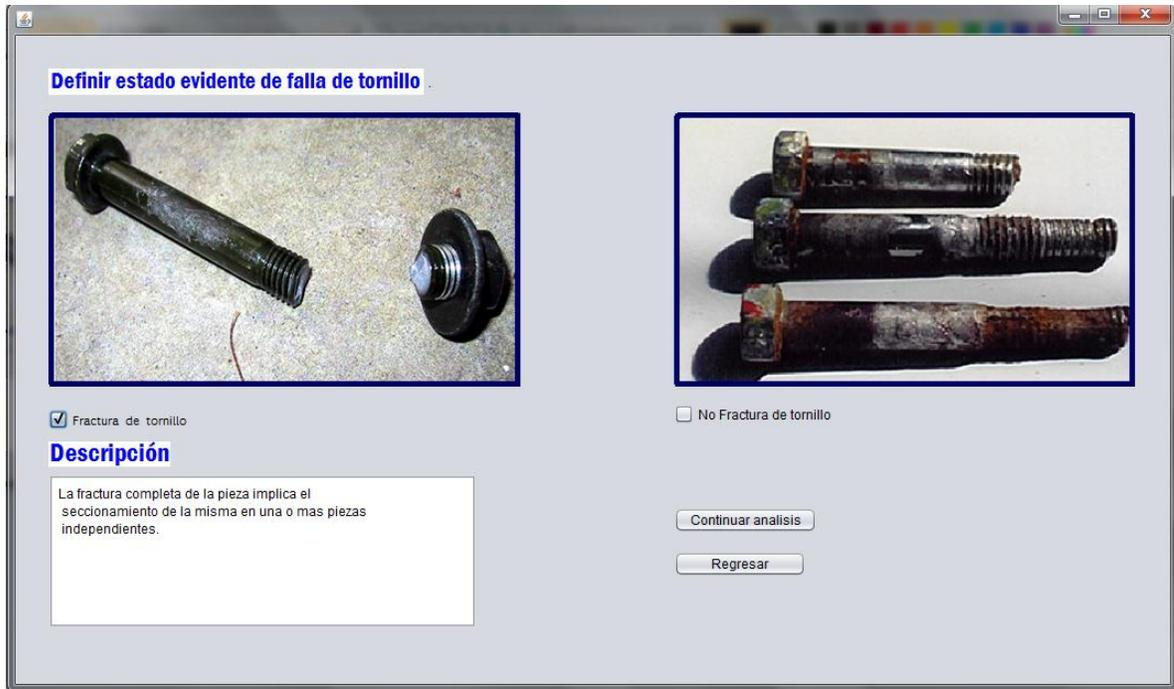
Figura B.30 Pantalla de inicio del sistema, se inicia el análisis de falla sobre la existencia de fractura en el tornillo.
