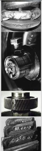
Figura C.10 Resultado del análisis (Fatiga superficial), segunda parte.
