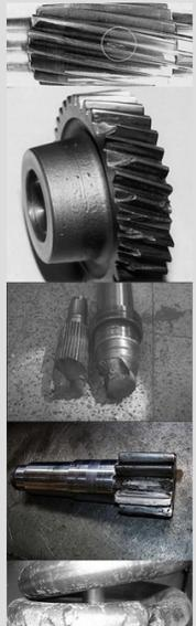
Figura C.9 Resultado del análisis (Fatiga superficial), primera parte.
