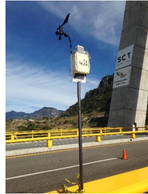
Figura 2.11 Instalación de acelerómetro en el Tirante 1 y de estación meteorológica
