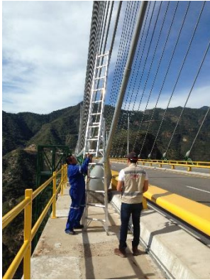
Figura 2.11 Instalación de acelerómetro en el Tirante 1 y de estación meteorológica
