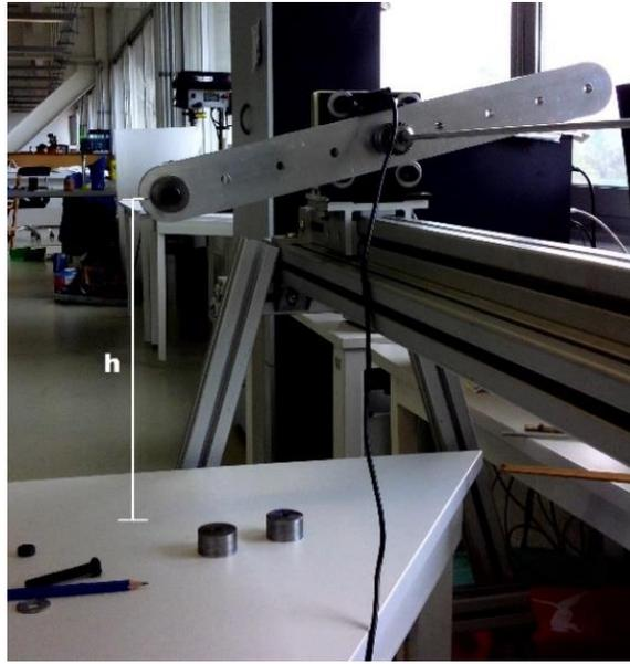
*Figura 4.9.* Arreglo para determinar la rigidez experimental de barra redonda de aluminio.
