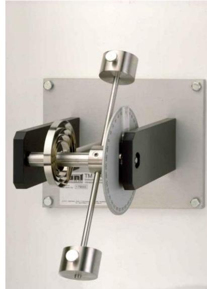
Figura 2.5. TM 164 Modelo de vibración torsional con resorte espiral. Fuente: GUNT Hamburg. (2016). *Equipos para la educación en ingeniería*. Recuperado de: [http://www.gunt.de/index.php?option=com\\_gunt&task=gunt.list.category&lang=es&category\\_id=19&product\\_id=1377](http://www.gunt.de/index.php?option=com_gunt&task=gunt.list.category&lang=es&category_id=19&product_id=1377)
