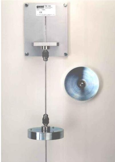
Figura 2.4. TM 163 Modelo de vibración torsional. Fuente: GUNT Hamburg. (2016). *Equipos para la educación en ingeniería*. Recuperado de: <http://www.gunt.de/es/productos/mecanica-y-diseño-mecanico/dinamica/vibraciones/vibraciones-torsionales/040.16300/tm163/glct-1:pa-150:ca-19:pr-1376>
