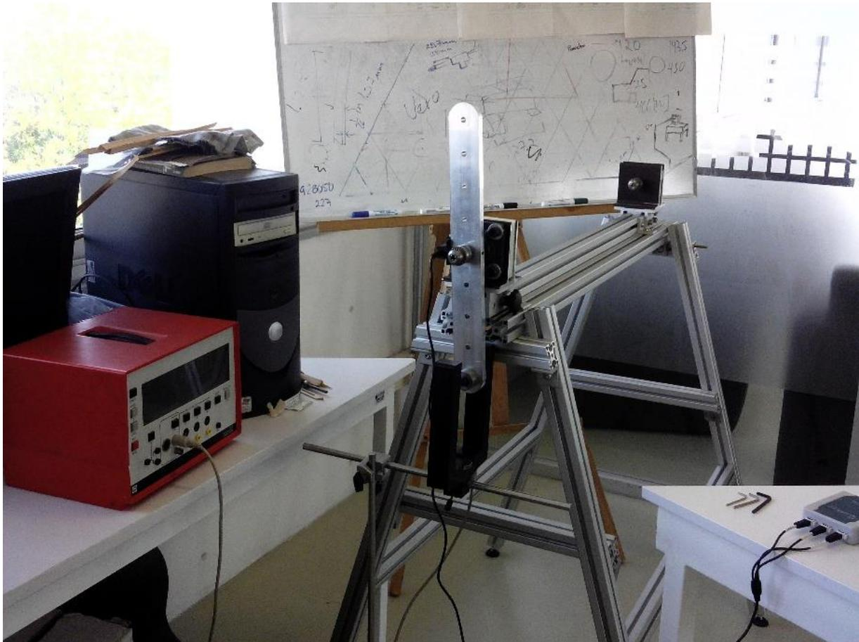
*Figura 3.11.* Arreglo de los sensores y brazo de torsión.
