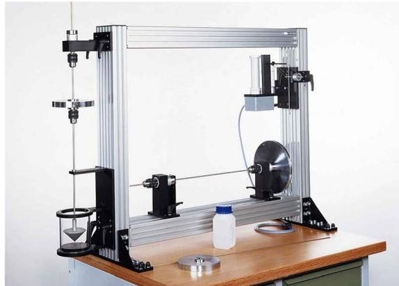
*Figura 2.3. TM 150.02 Vibraciones torsionales libres y amortiguadas. Fuente: GUNT Hamburg. (2016). Equipos para la educación en ingeniería. Recuperado de: <http://www.gunt.de/es/productos/vibraciones-torsionales-libres-y-amortiguadas/040.15002/tm150-02/glct-1:pa-150:pr-1368>*
