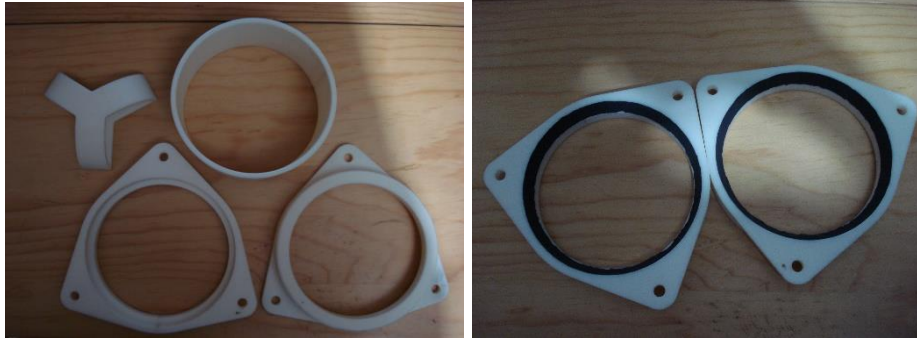
Figura 3.8. Sujetadores, manija y cilindro impresos en 3D (izquierda) y sujetadores con sello de foami (derecha).
