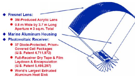
Figura 1.10. Módulo de concentración ENTECH de cuarta generación. [1.4]
