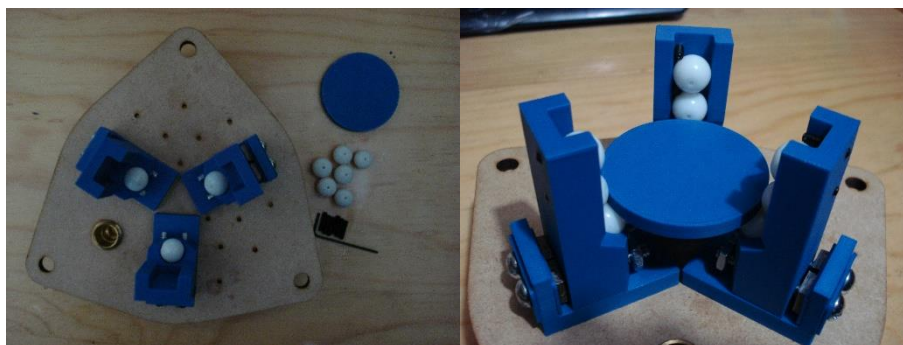
Figura 3.13. Base de la cámara de reacción y piezas para el montaje de la probeta de 50.8\text{ mm} ( 2\text{ in} ) de diámetro (izquierda), e imagen de la probeta ya montada en el sujetador (derecha).
