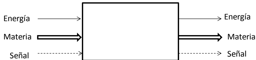
Figura 2.1. Estructura general del diagrama de funciones con sus tres tipos de entradas y salidas usuales (energía, materia y señal) [2.2].
