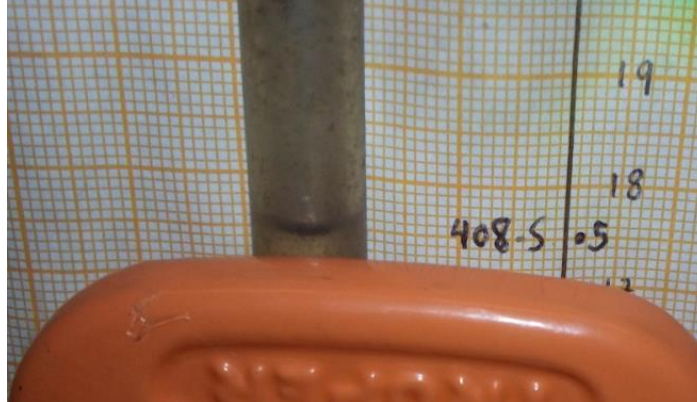
Figura 3.24a. Gasto de 408.5 l/s (primera prueba).
