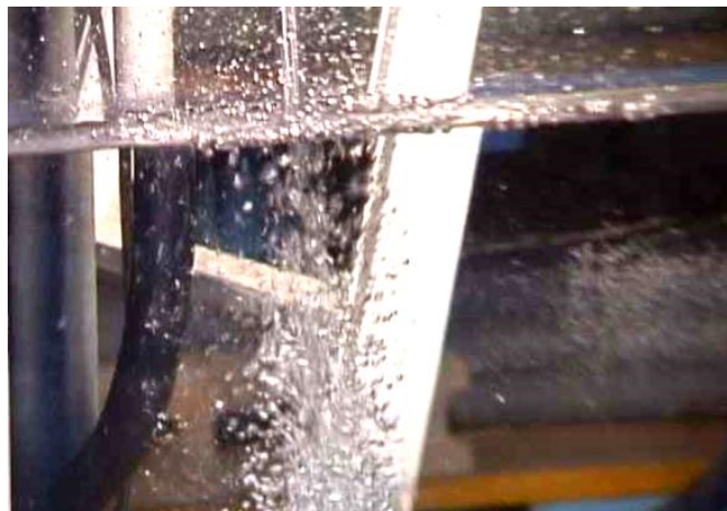
Figura 1.23. Entrada de aire en la inmersión de un chorro libre (Foto: Chanson, 2002).
