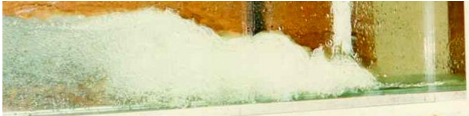
Figura 1.26. Entrada de aire en un salto hidráulico causado por vórtices con ejes perpendiculares a la dirección del flujo (Foto: Chanson, 1999).
