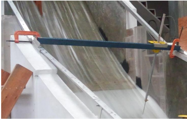
Figura 3.27a. Sonda colocada sobre el aireador.
