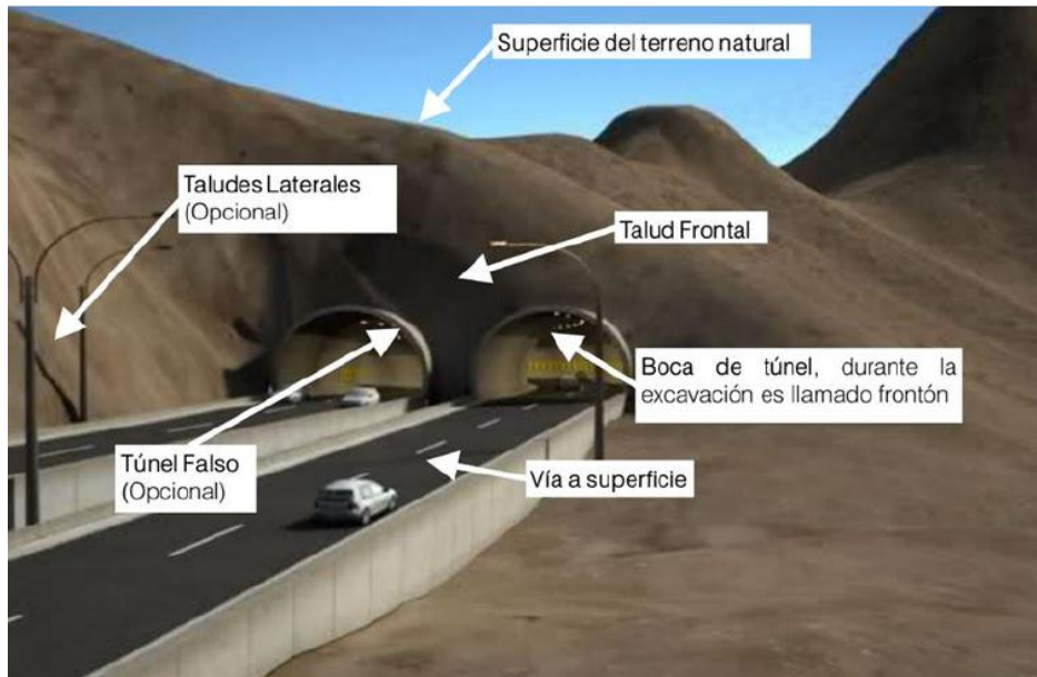
Figura 1-3. Elementos del portal de un túnel. Fuente: INVIAS, 2015
