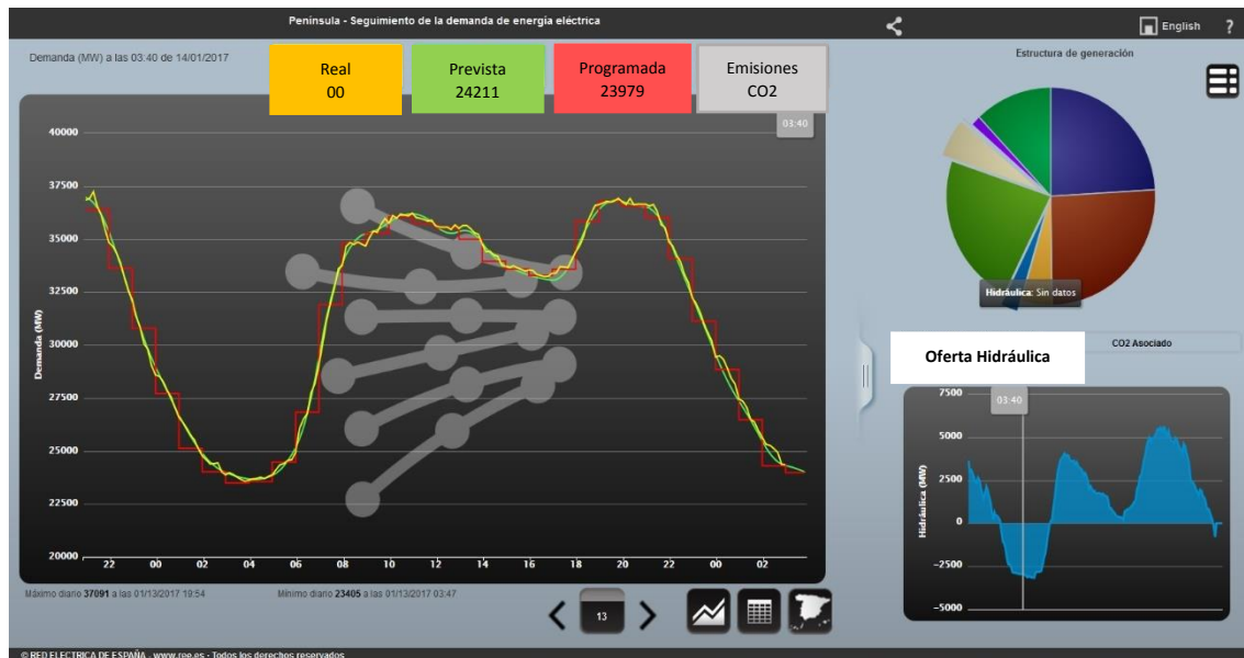
Figura 2-5 Seguimiento de la demanda de energía eléctrica, sistema peninsular
