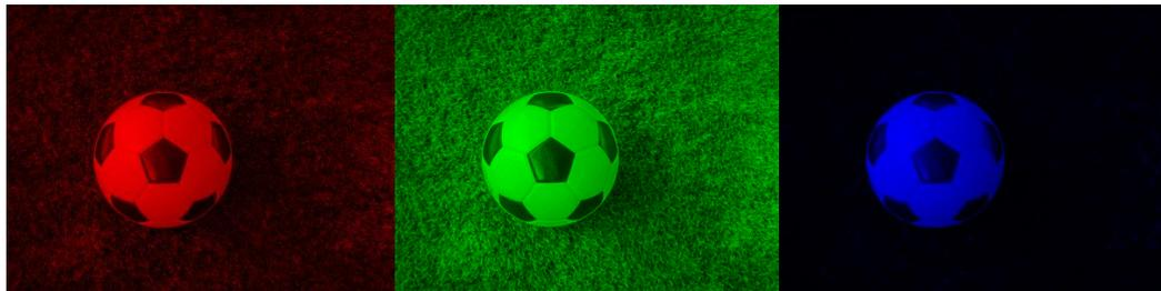
*Ilustración 2-7 Descomposición de la imagen de un balón en los colores primarios RGB*
