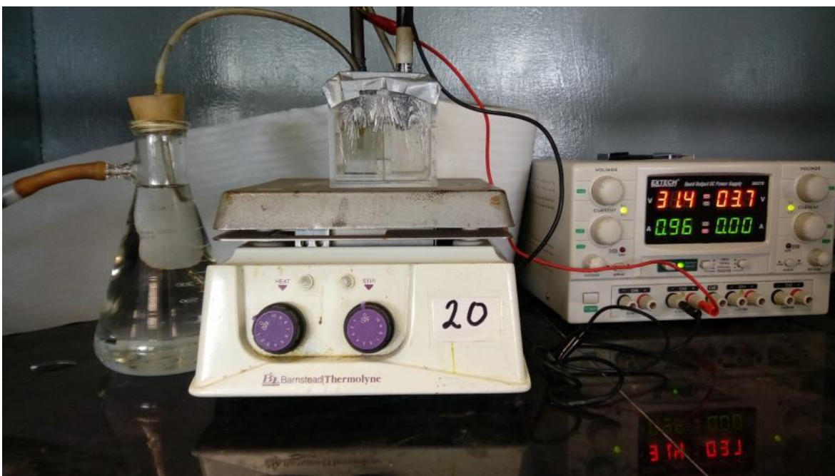
Ilustración 20 Montaje celda electrolítica
