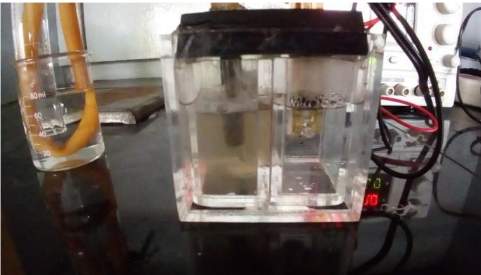
Ilustración 28 Apariencia de soluciones durante el amperaje máximo. Izquierda: Solución de NaCl. Derecha: Agua destilada
