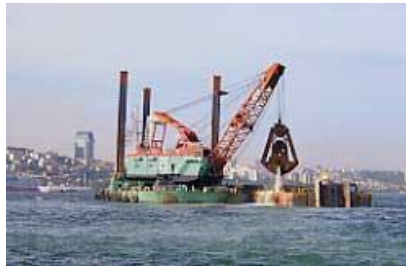
Ilustración 5-7 , Draga de cuchara, removiendo piedras en el canal de Tunkey
