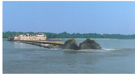
Ilustración 5-8, Draga Dustpan (© 2000-2017 GlobalSecurity.org).
