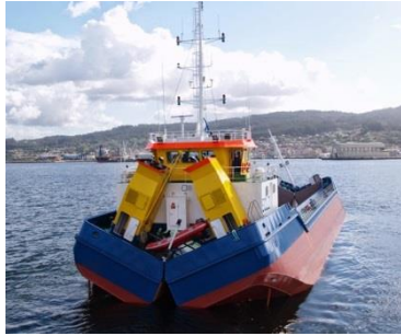
Ilustración 4-5, Gánguil de casco partido, descarga por gravedad. (Clara Lahiguera, 2015)
