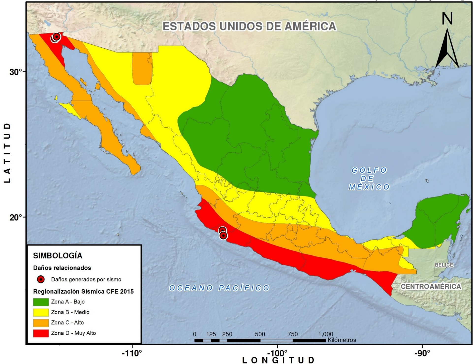
Fig.5.14. Regionalización Sísmica CFE (Atlas Nacional de Riesgos - CENAPRED) y daños generados por sismo
