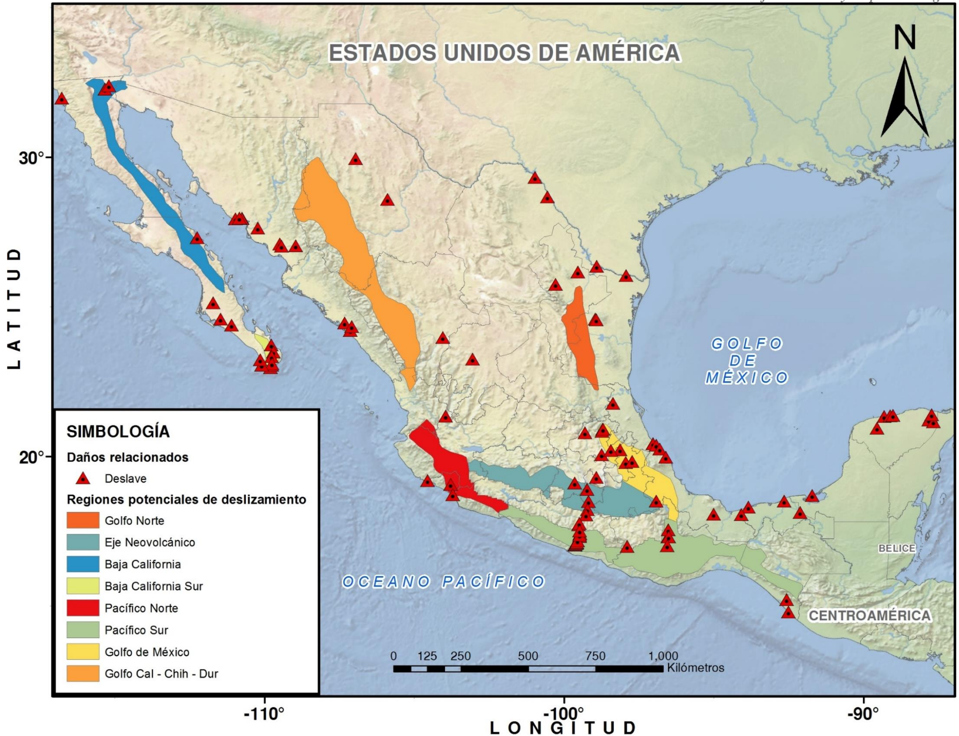
Fig.5.11. Regiones potenciales de deslizamiento (Atlas Nacional de Riesgos - CENAPRED) y daños por deslaves
