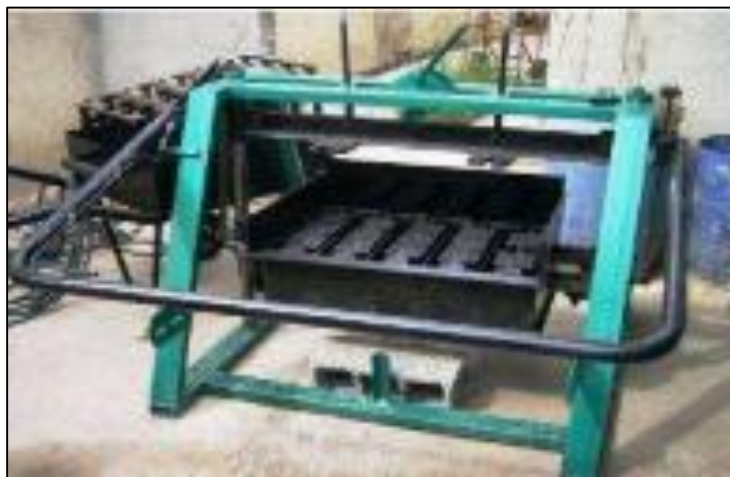
Figura 1.1 Máquina bloquera manual 1 (Corzo y Cuatin, 2011)
