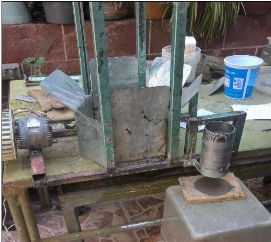
Figura 4.16 Unión del cilindro a la estructura del molde
