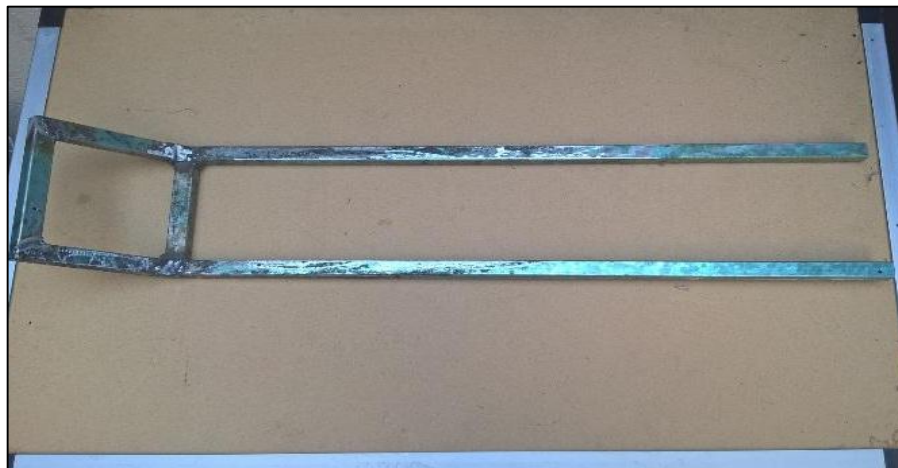
Figura 4.11 Estructura para la tapa del molde
