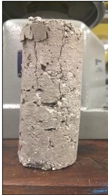
Figura 4.31 Probeta ensayada a compresión
