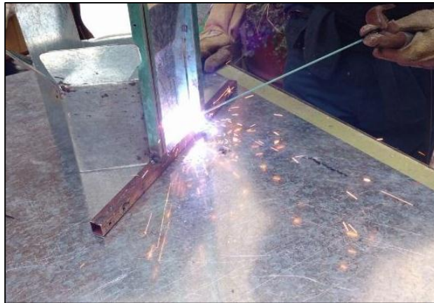
Figura 4.14 Unión de estructura y molde
