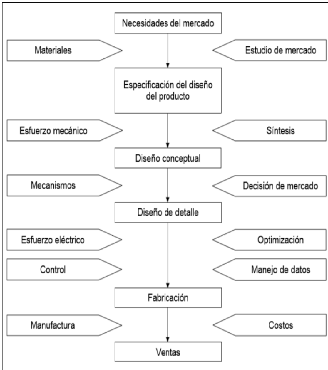
Figura 2.3. Esquema del modelo de diseño de Pugh (Pugh, 1991)
