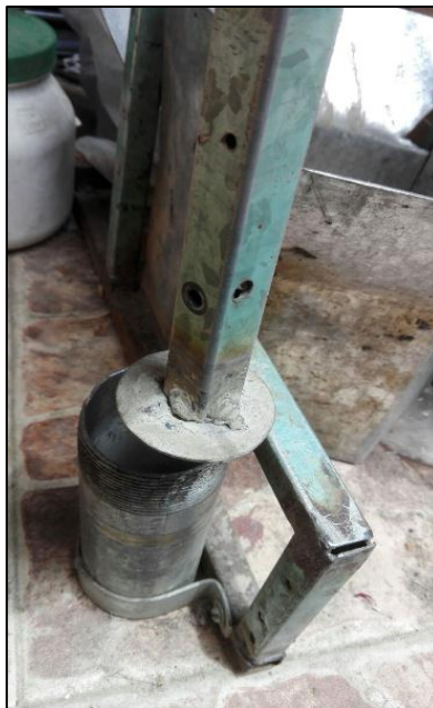
Figura 4.17 Cilindro y tapa para fabricación de probetas
