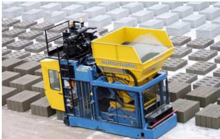
Figura 1.6 Máquina móvil de prefabricados de concreto (Corzo y Cuatin, 2011)
