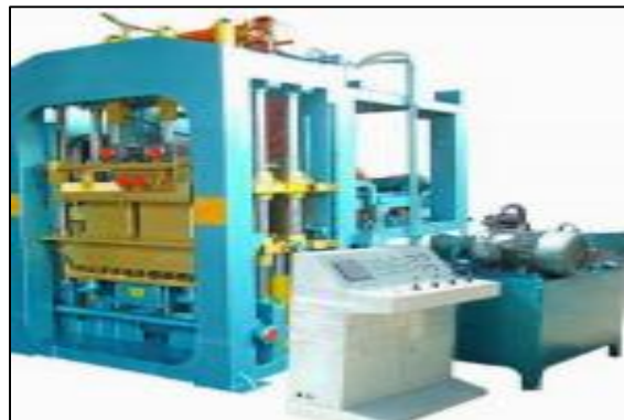
Figura 1.4 Máquina automática de prefabricación de concreto (Corzo y Cuatin, 2011)
