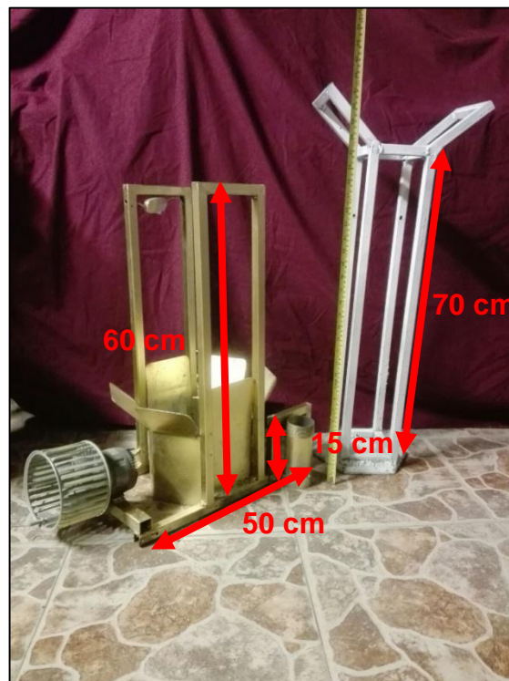
Figura 4.20 Herramienta terminada para la fabricación de adoquines
