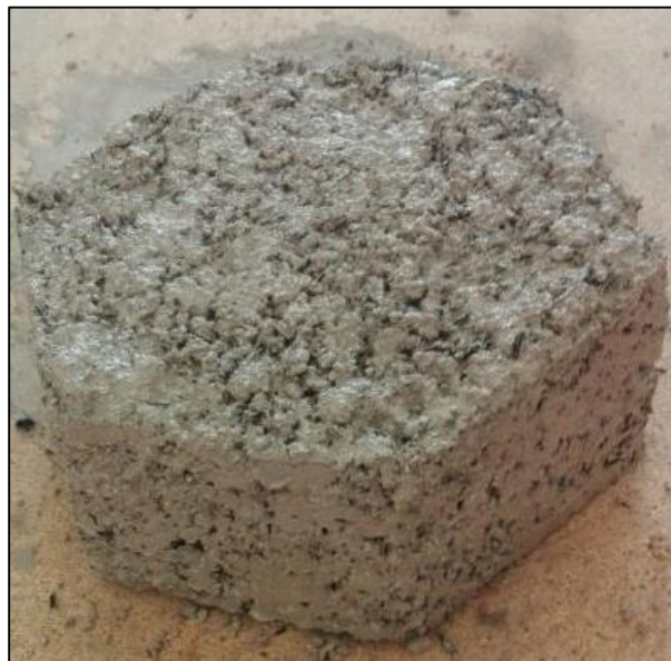
Figura 4.32 Adoquín hecho con mezcla B-2
