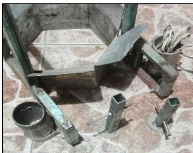
Figura 4.18 Cilindros y tapas para fabricación de probetas
