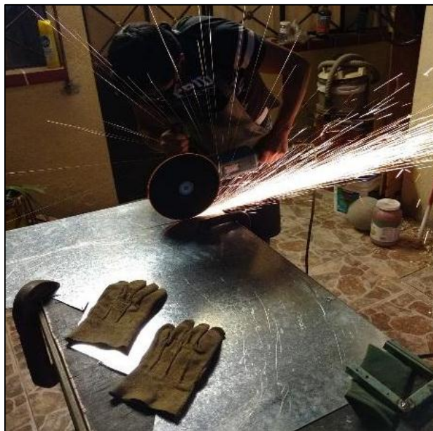
Figura 4.5 Corte de lámina galvanizada
