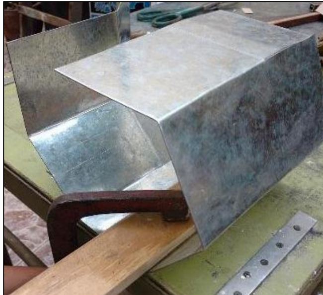
Figura 4.6 Doblado de lámina galvanizada
