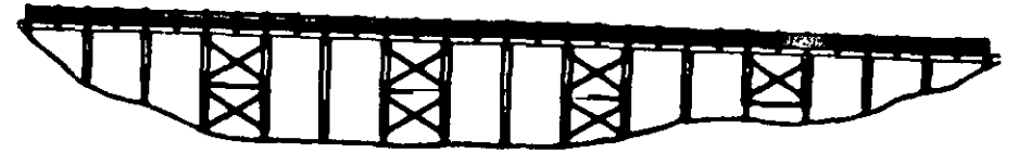
VIADUCTO DE MADERA
