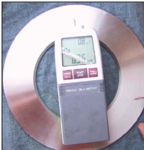
Fig. 3.8 Medición de rugosidad.
