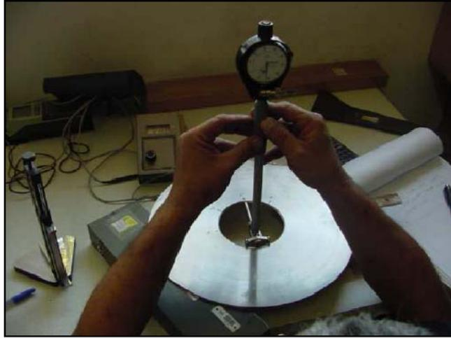
Fig. 3.10 Medición del diámetro de orificio.
