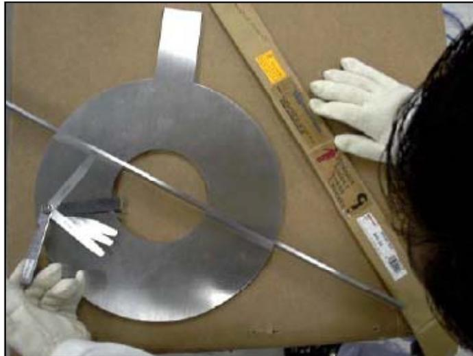
Fig. 3.7 Medición de desviación de planitud.
