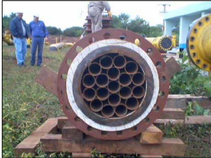
Fig. 3.31 Enderezador de flujo.
