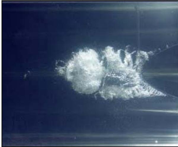
Fig. 1.21 Cavitación en una tubería.
