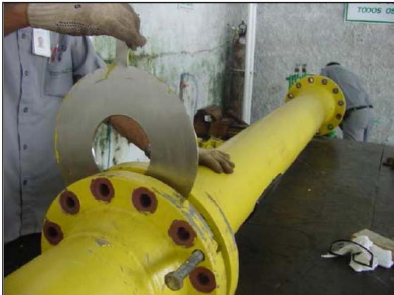
Fig. 3.30 Remoción de placa de orificio en brida.
