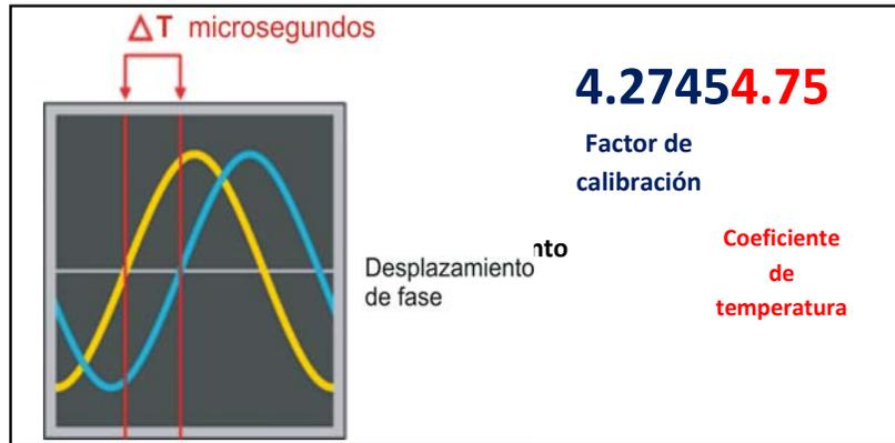
Fig. 4.21 Factor de calibración para medidor Coriolis.
