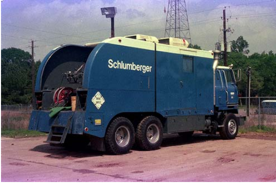
Figura 6.3 Equipo básico para todas las operaciones de campo de Schlumberger, en un camión de registro, fácilmente reconocibles por su característico color azul adoptada en 1936, se convirtió en un elemento indispensable de las operaciones de asociados a la perforación del pozo (Tomado de http://oil-mail.blogspot.mx/2011/05/en-1912-conrad-schlumberger-utilizando.html , 2011).
