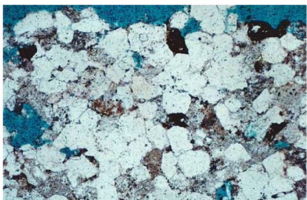
Figura 6.14 fotografía que muestra poros permeables en una formación tight gas . (tomado www.energy.usgs.gov )
