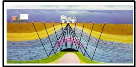
Figura 2.14 (b) Esquema del arreglo del equipo para toma de datos sísmicos en continente ( seismic onshore ) (www.kgs.ku.edu,2016)
