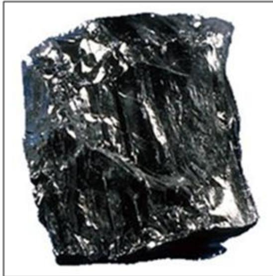
Fig. 1.4 Muestra de carbón antracítico
