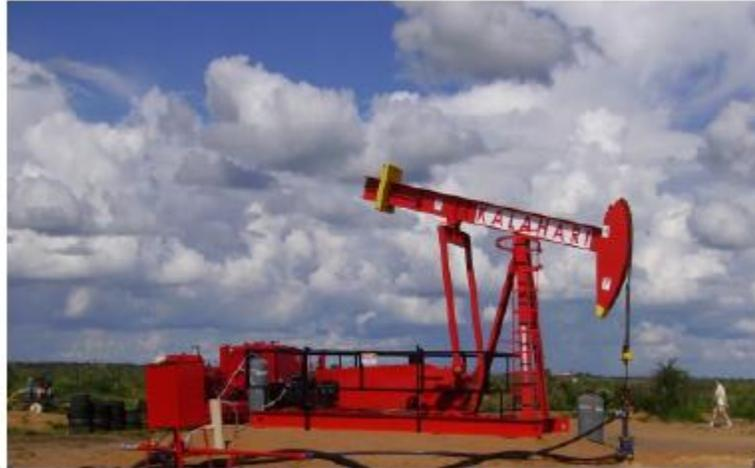
Fig. 4.6 Proceso de bombeo de agua "Dewatering"
